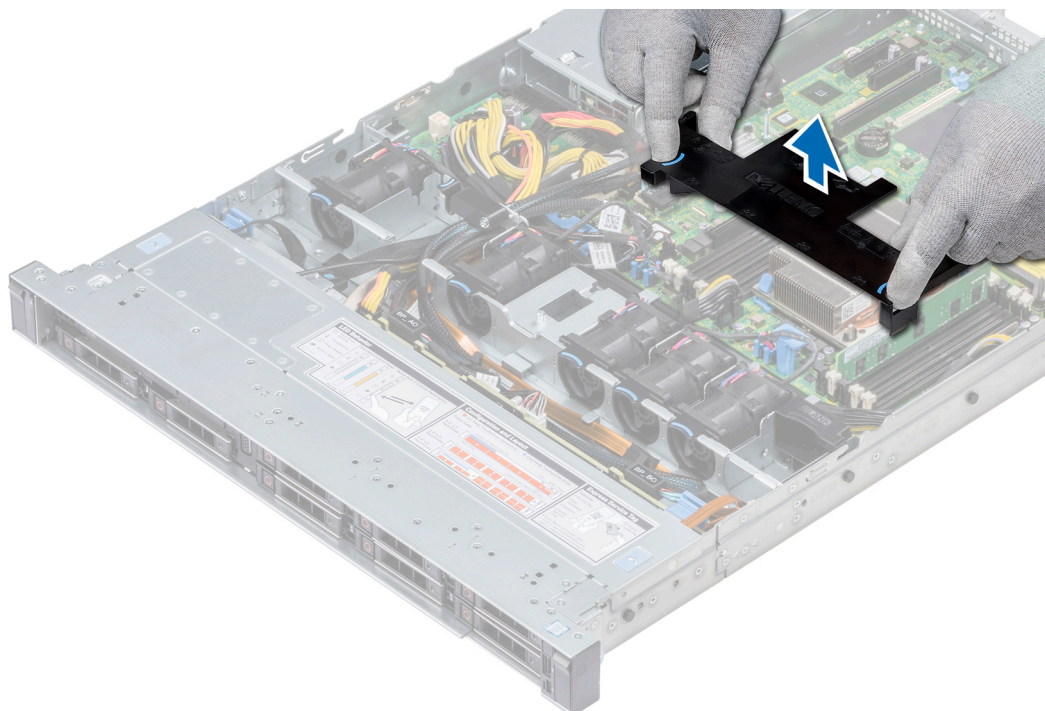
Figure 23. Retrait du carénage d'aération
