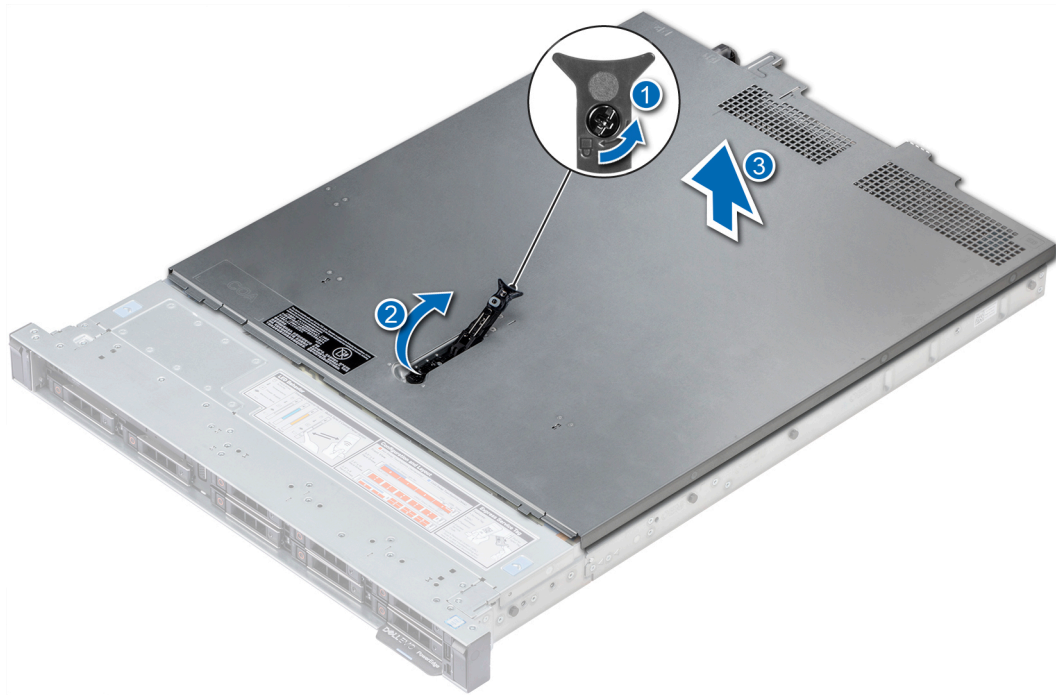
Figure 18. Retrait du capot du système
