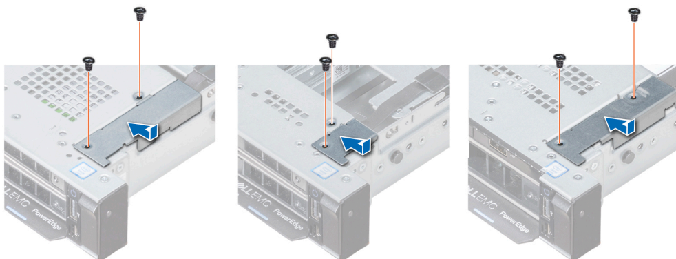
Figure 111. Installation du cache-câbles
