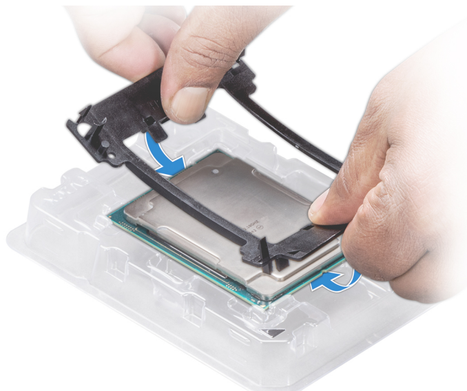
Figure 45. Installation du support de processeur
