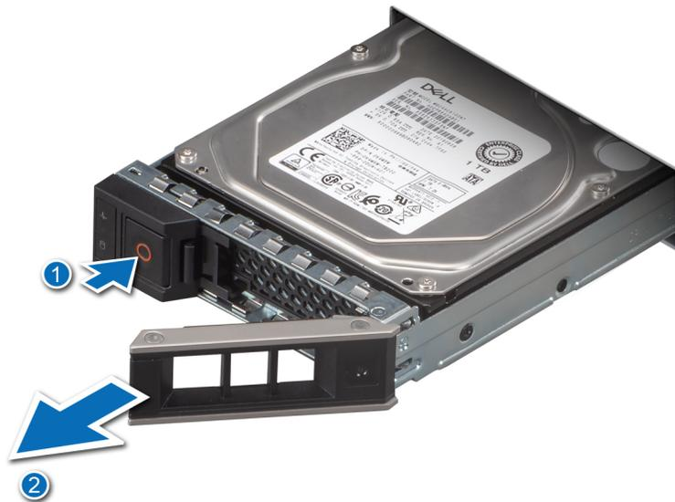
Figure 21. Retrait d'un disque remplaçable à chaud
