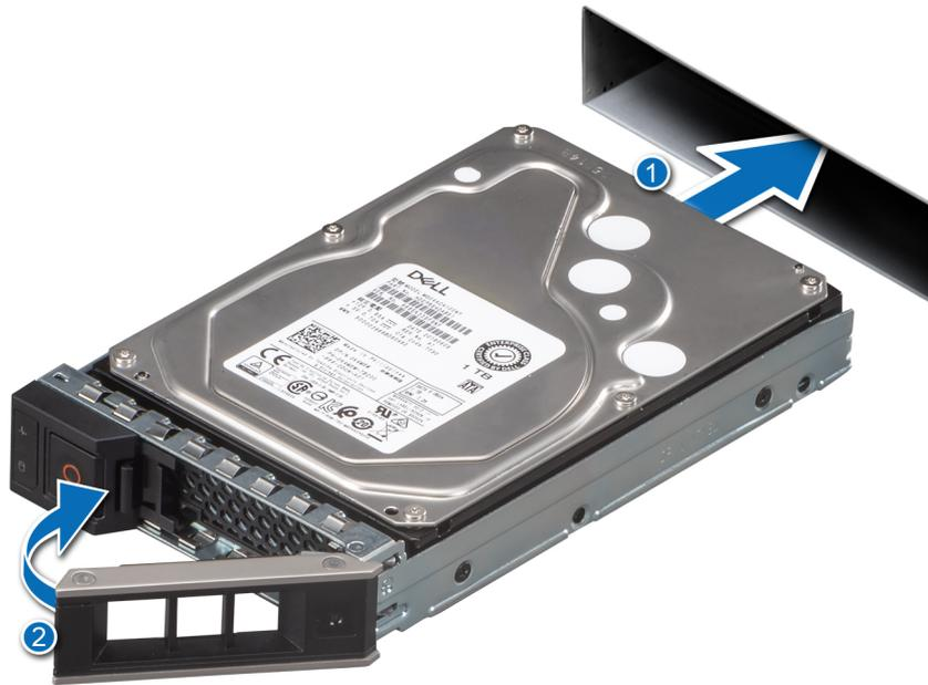
Figure 22. Installation des disques remplaçables à chaud
