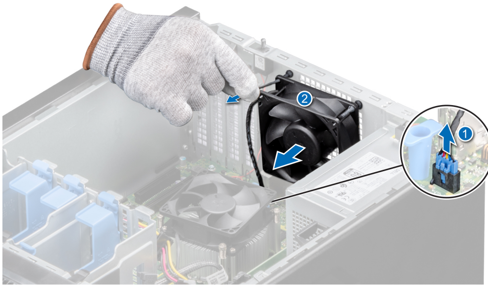
Figura 26. Extracción del ventilador de refrigeración
