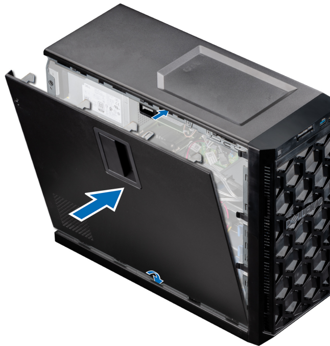
Figura 10. Instalación de la cubierta del sistema
