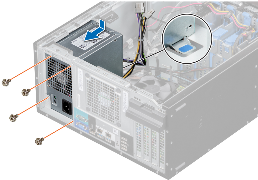
Figura 45. Instalación de la PSU
