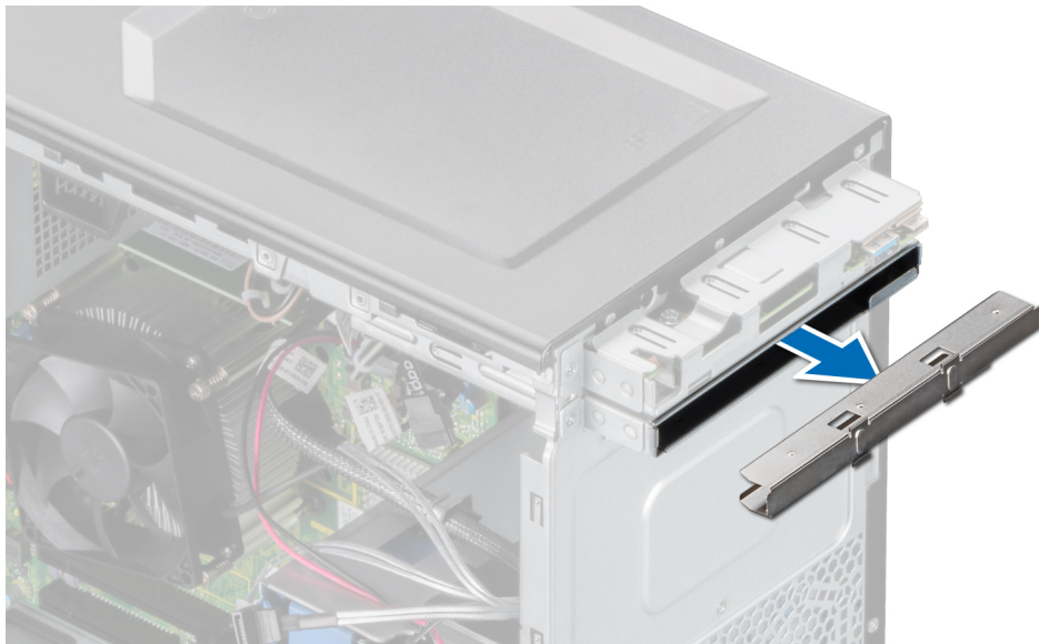
Figura 18. Extracción de la unidad óptica de relleno de la canastilla para unidad óptica
