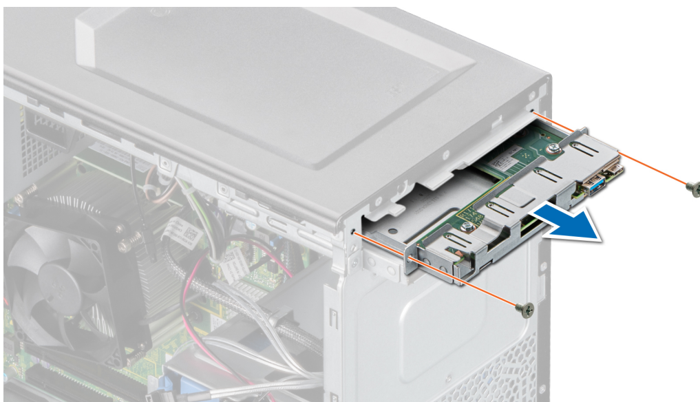
Figura 54. Extracción de la canastilla del panel de control
