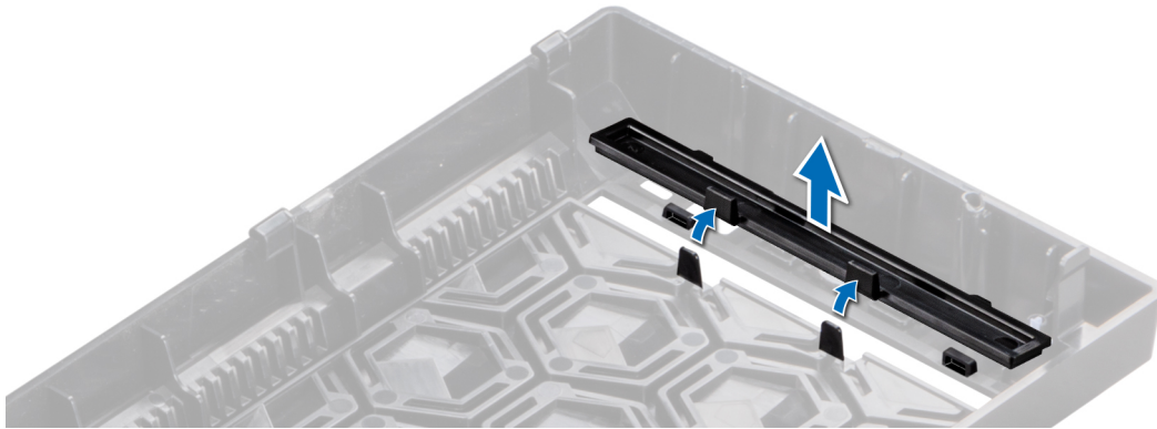
Figura 17. Extracción de la unidad óptica de relleno del bisel frontal
