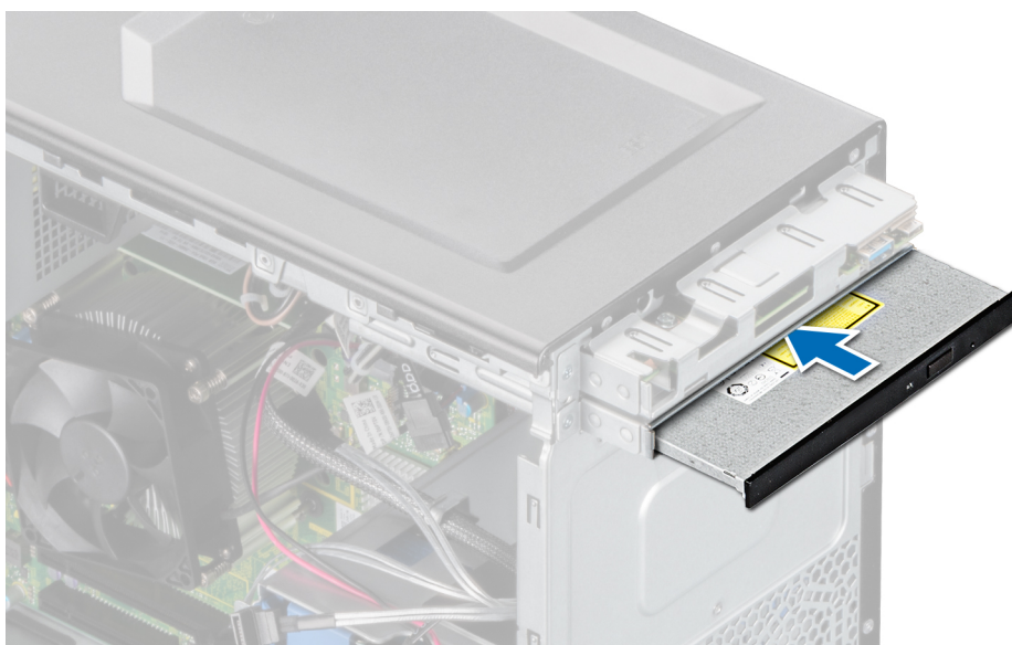
Figura 22. Instalación de la unidad óptica
