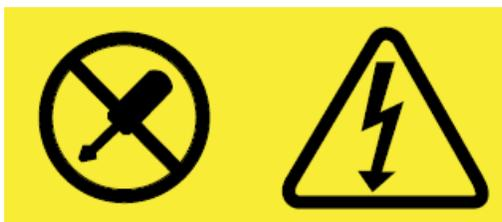
I componenti su cui è presente questa etichetta sono soggetti a voltaggio, corrente e livelli di energia pericolosi. In questi componenti non sono presenti parti sostituibili. In caso di problemi con uno di questi componenti, contattare un tecnico di manutenzione.
