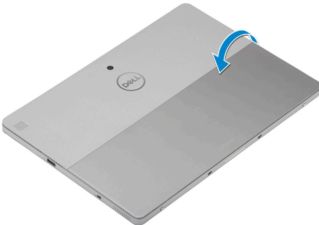
**REMARQUE :** Faites levier sous le port de la station d'accueil et déplacez-le délicatement dans le sens horaire afin de ne pas endommager les attaches en plastique. Utilisez une pointe en plastique.
