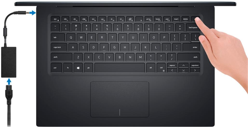
**NOTA:** Para conservar la energía de la batería, es posible que esta ingrese en modo de ahorro de energía. Para encender el equipo, conecte el adaptador de alimentación y presione el botón de encendido.
