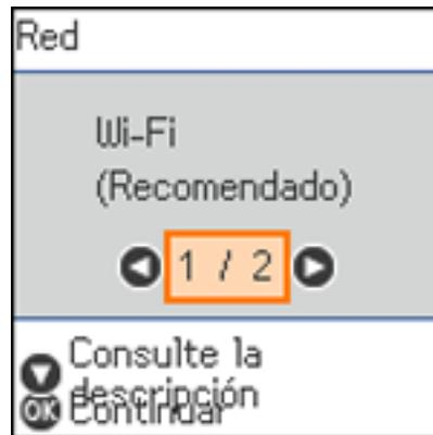
3. Pulse los botones de flecha para seleccionar **Wi-Fi Direct** y pulse el botón **OK**.
