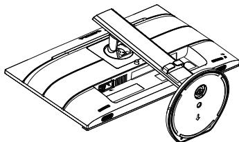
3. Нажав кнопку фиксатора, наклоните основание и извлеките его.
