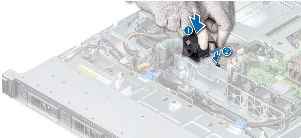
Figure 18. Installing a fan
