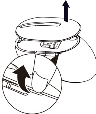
2. Entfernen Sie den USB-Dongle aus seinem Fach.
