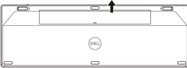
2. Legen Sie die AA-Batterien in das Batteriefach ein.
