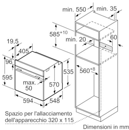
Montaggio con un piano di cottura.
