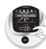
4. هنگامی که اصلاح تمام تنظیمات شما به پایان رسید، دکمه "Start" (B7) را برای شروع برنامه فشار دهید. هنگامی که دستگاه شما از حالت پخت و پز استفاده می کند، چراغ نشانگر فرمز (B3) روشن می شود تا به شما اطلاع دهد که پخت و پز شروع شده است.
