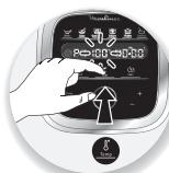
2- Os parâmetros pré-programados podem ser modificados para uma receita (consoante a receita escolhida, os ingredientes, as quantidades preparadas). Prima o seletor de velocidade (**B2**) ou o seletor de temperatura de cozedura (**B3**) ou o seletor de tempo (**B4**), o parâmetro escolhido pisca no ecrã (**C1-C2-C3**).
