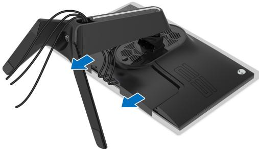
5. Trennen Sie die Kabel vom Monitor und schieben Sie sie durch die Kabelführungsöffnung am Ständer.
