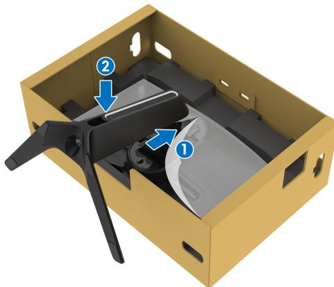
7. Verlegen Sie das Netzkabel durch den Kabelführungsschlitz am Ständer und durch den Kabelführungsklemme an der Rückseite des Monitors.
