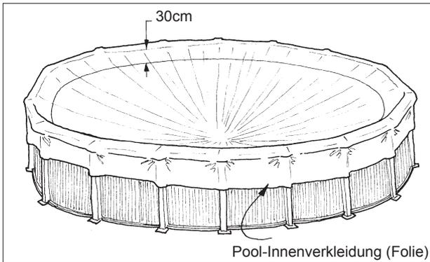
Arbeiten Sie beim Entfalten in beide Richtungen und lassen Sie die Innenverkleidung ungefähr 60 cm über den Beckenrand hängen. Die Mitte der Folie muss noch ungefähr 40 cm über dem Boden hängen. Die Bodenschweißnaht der Folie ist dann ungefähr 30 cm vom inneren Beckenrand entfernt (siehe Skizze).
