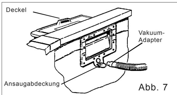
Vergewissern Sie sich, dass sich keine Luft unter dem Deckel befindet. Eingeschlossene Luft drückt den Deckel hoch.
