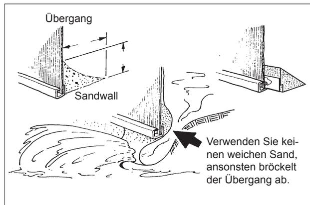
Wichtiger Schritt: Bringen Sie an der Innenseite der Stahlwand einen schrägen, nach unten ablaufenden Übergang aus stabilisiertem Sand von ungefähr 15 cm Höhe und Breite an (Mischverhältnis 1m<sup>3</sup> Flusssand mit 125 kg Zement). Dieser kleine Wall dient zum Schutz der Innenverkleidung und ist äußerst wichtig. Durch den Wasserdruck kann sonst die Folie unter die Bodenschiene nach außen gedrückt werden.
