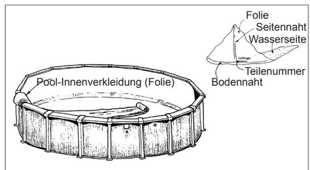
Entfernen Sie den Pfahl in der Mitte und überprüfen Sie den Boden nochmals auf Kies, Glas oder andere spitze Gegenstände. Fußabdrücke und andere Unebenheiten eibeben. Es empfiehlt sich, den Boden zum Schutz der Pool-Innenverkleidung mit einer wasserdichten Teppichunterlage zu bedecken, die Sie mit Klebeband an der Unterseite der Stahlwand festkleben können. Platzieren Sie anschließend die Innenverkleidung auf den Randschienen und überprüfen Sie sie entsprechend den Angaben.
