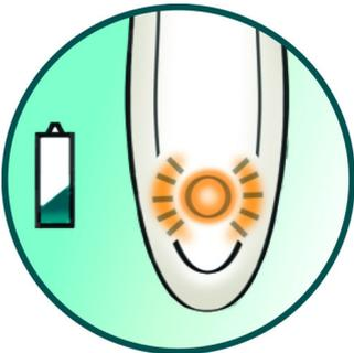
Indique un niveau de batterie faible et vous rappelle de charger l'appareil avant la prochaine utilisation
