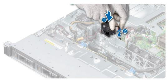
Figure 18. Installing a fan
