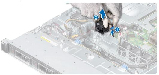
Figure 17. Removing a cooling fan
