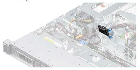
Figure 15. Removing the fan blank
