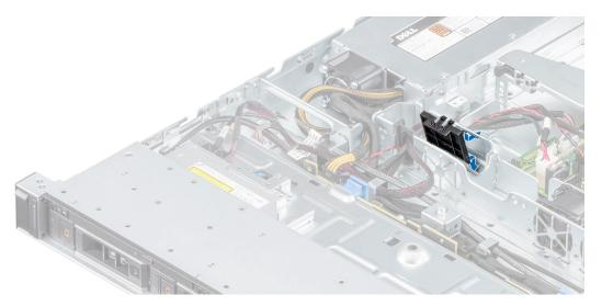
Figure 16. Installing the fan blank
