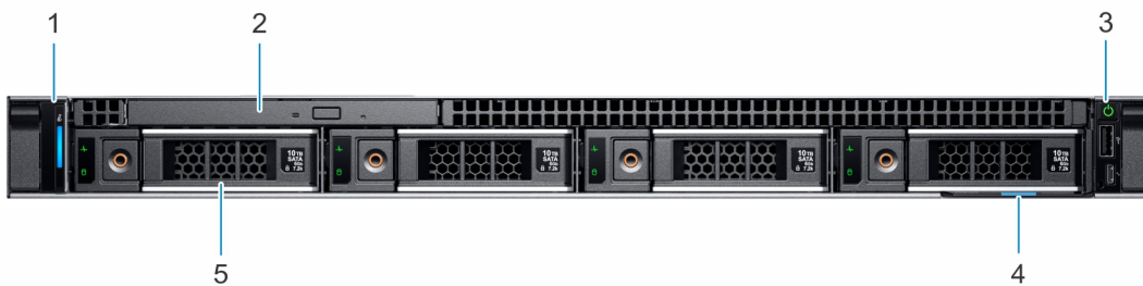
Figura 1. Vista frontal del sistema de unidad de 4 x 3.5 pulgadas
