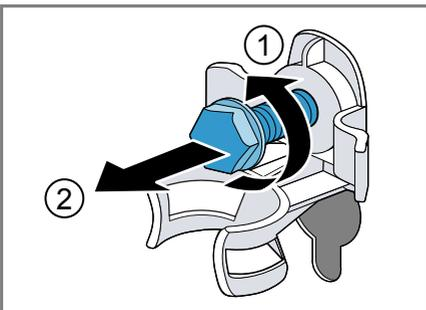
3. Die Netzanschlussleitung aus der Halterung ziehen.
