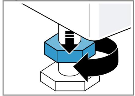
2. Um das Gerät auszurichten, die Gerätefüße drehen. Die Ausrichtung mit einer Wasserwaage prüfen.
