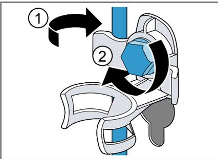
5. Den Schlauch in die Halterung einsetzen.
