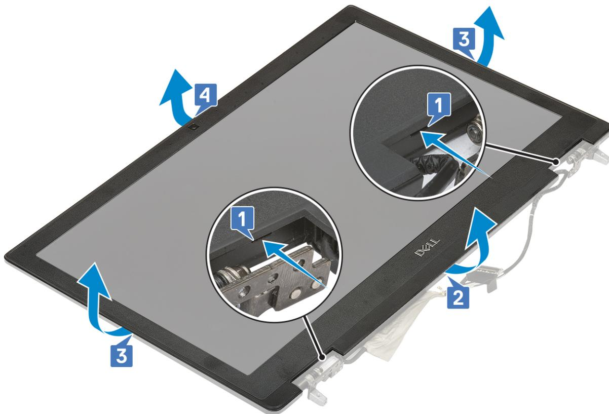
**i** **N.B.:** La cornice del display per modelli non touch-screen è un componente rimovibile e deve essere sostituita con una nuova ogni volta che viene rimossa dal sistema.
