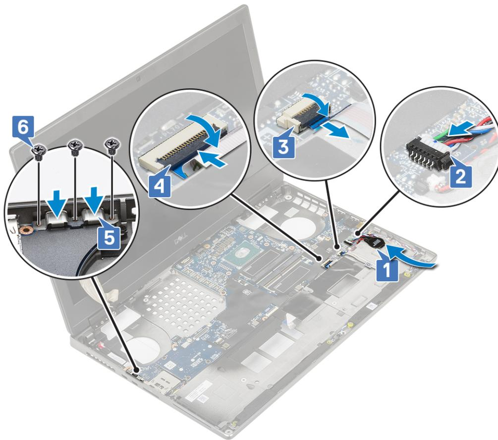
f) Collegare il cavo del connettore di alimentazione ai connettori sulla scheda di sistema .
