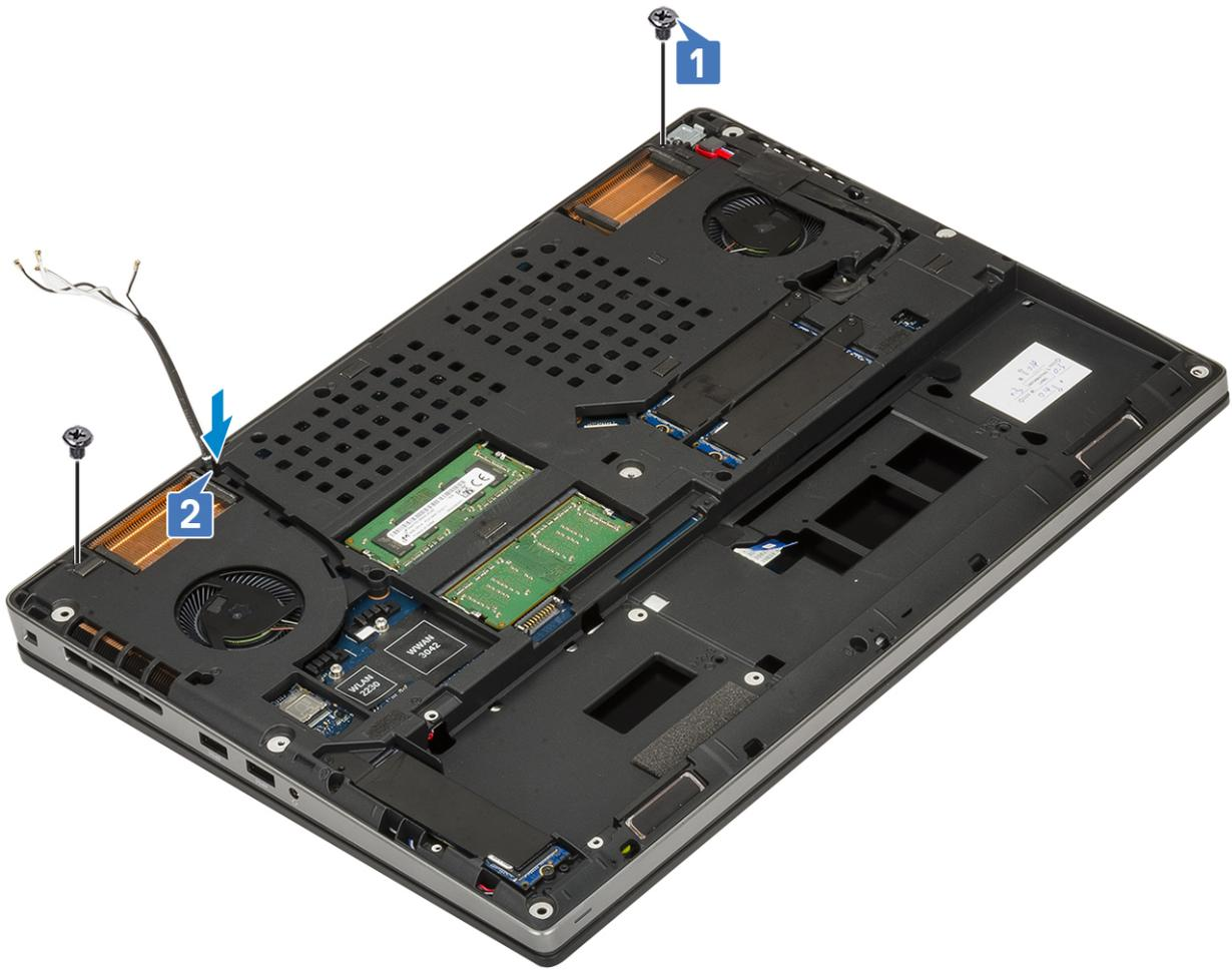
c) Rimuovere le 2 viti (M2.5x6.0) sul retro del sistema che fissano il gruppo del display in posizione.
