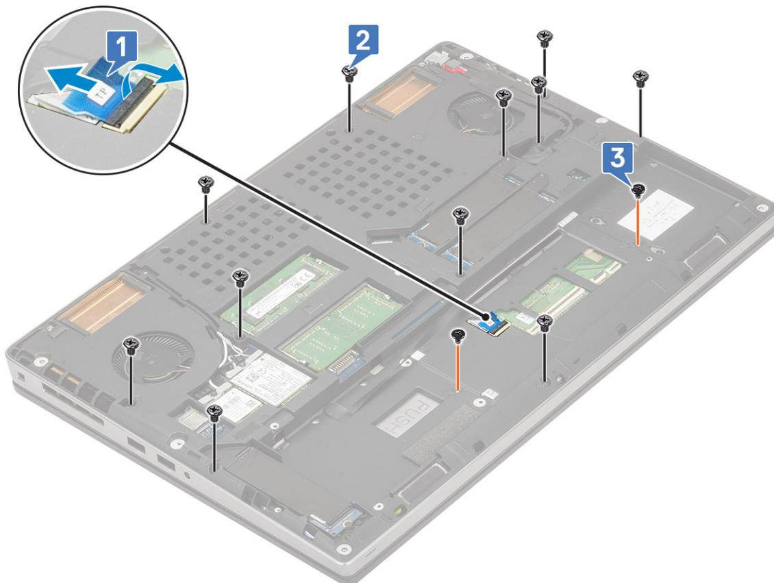
c) Capovolgere il computer e scollegare i cavi della scheda di sistema e del pulsante di alimentazione dai connettori sulla scheda di sistema [1, 2].
