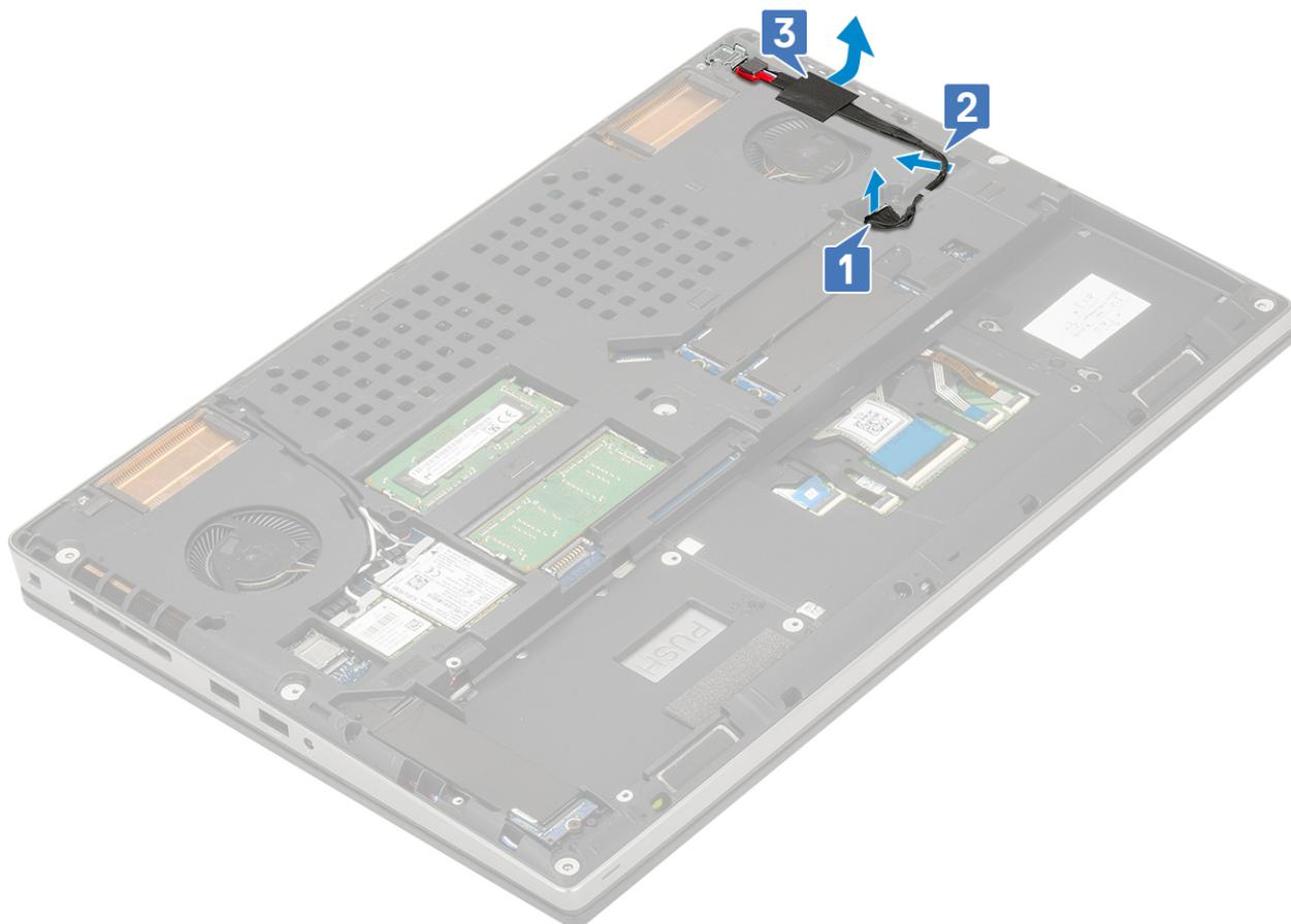
c) Rimuovere la vite (M2.0x5.0) che fissa la staffa metallica del cavo del connettore di alimentazione al sistema [1].
