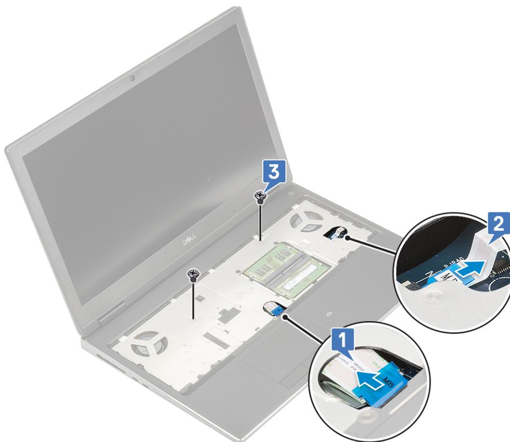
e) Spingere il foro nella parte inferiore del sistema per rilasciare il supporto per i polsi dalla parte inferiore del telaio.
