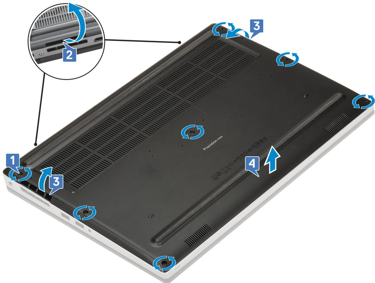
**① N.B.:** Quando si fa leva sul coperchio della base, usare mani o un graffietto in plastica: non usare altri oggetti affilati per evitare di danneggiare il telaio
