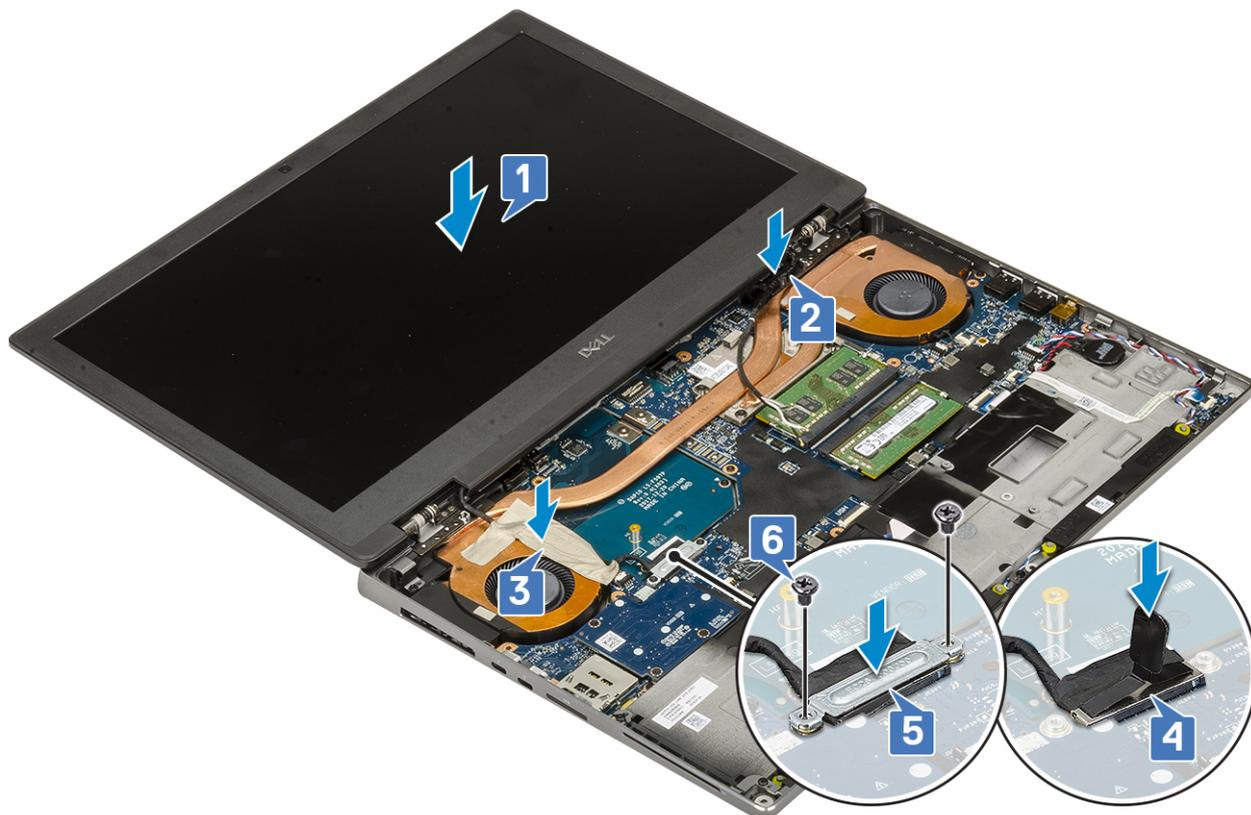
f) Allineare i cappucci dei cardini del display e ricollocare le 4 viti (M2.5x4.0) per fissare i cappucci delle cerniere del display al sistema [1, 2].
