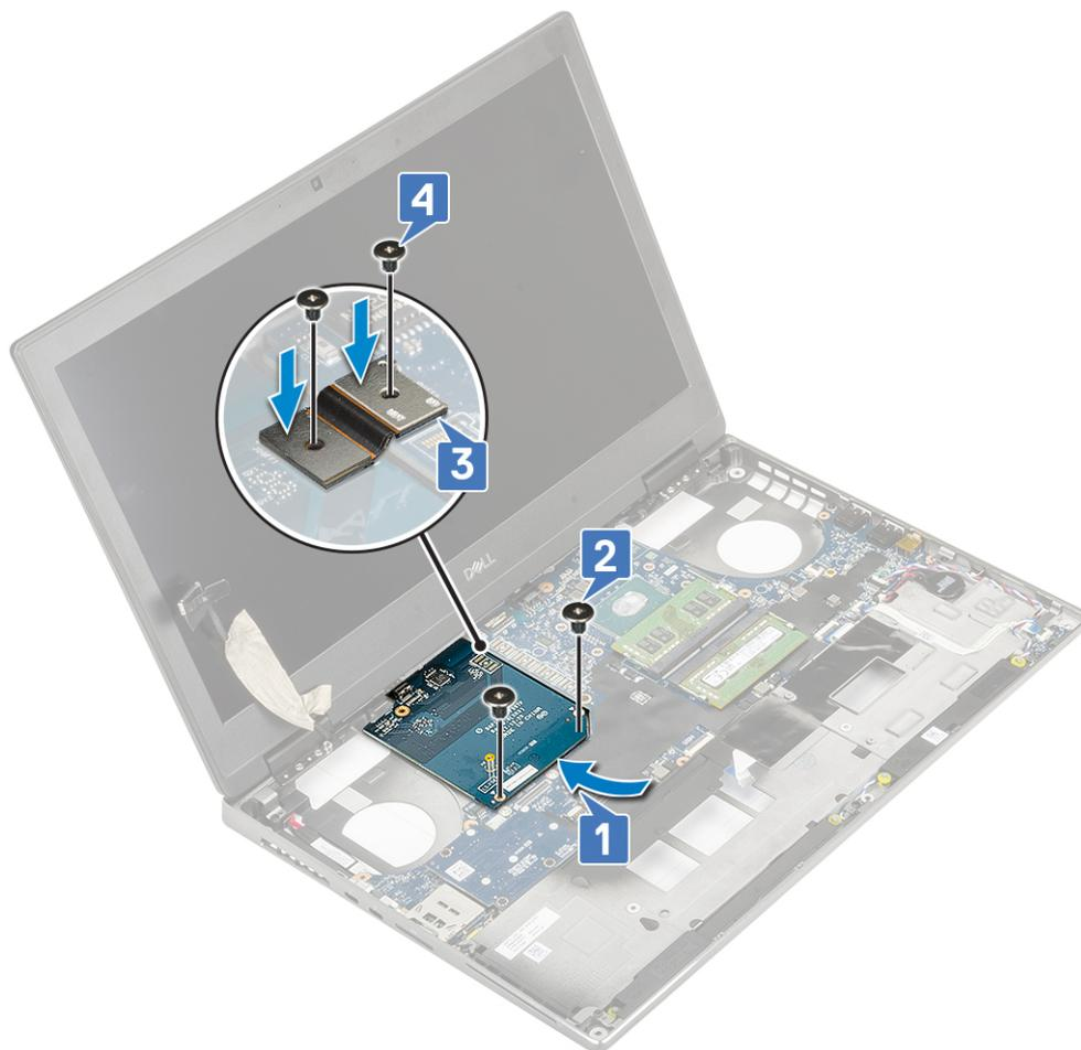
2. **N.B.:** Le procedure descritte sopra riguardano la scheda grafica UMA. I sistemi dotati di scheda GPU UMA non possiedono un cavo di alimentazione della GPU. Tuttavia, per i modelli dedicati dotati di scheda GPU VRAM da 128 MB o 256 MB, è necessario collegare il cavo di alimentazione della GPU dopo aver installato la scheda.
