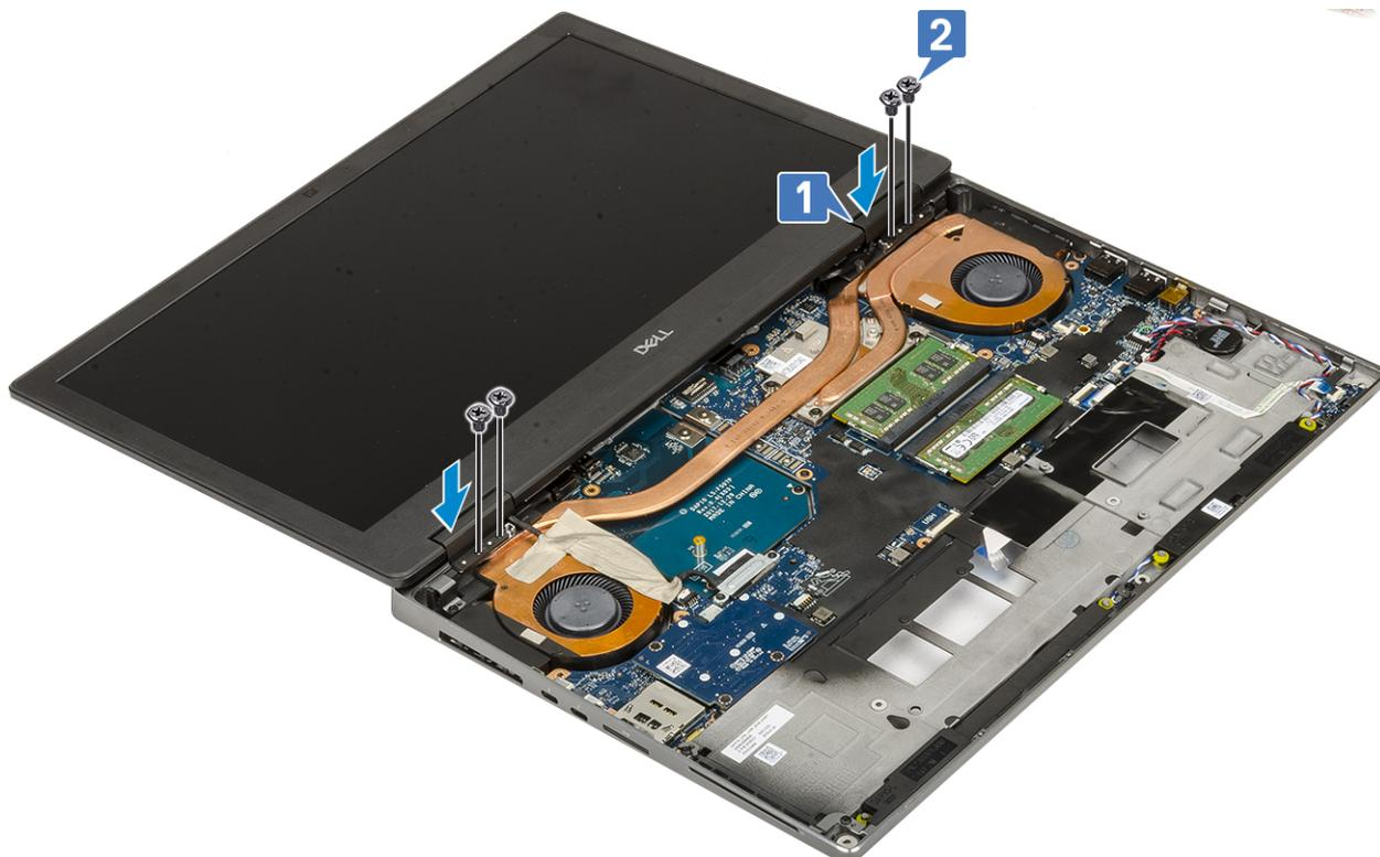
g) Chiudere il gruppo del display e ricollocare le 2 viti (M2.5x6.0) sul retro del sistema per fissare il gruppo del display in posizione.
