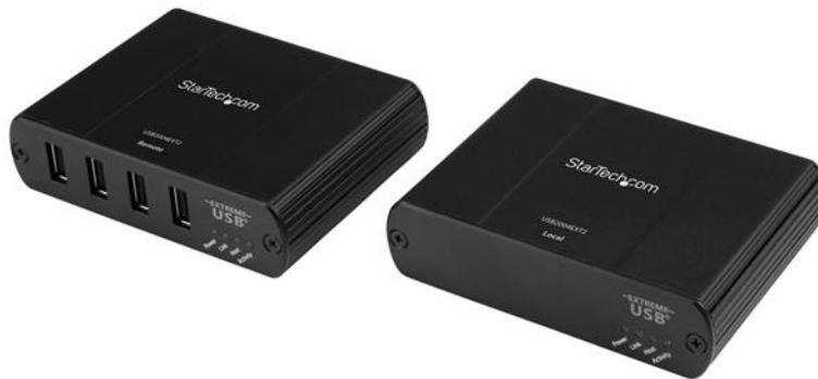
El extensor USB de 4 puertos, modelo USB2004EXT2, permite extender dispositivos USB 2.0 mediante un cable Ethernet Cat 5 o superior a distancias de hasta 100 metros. Un adaptador de alimentación en el extremo remoto proporciona hasta 500 mA de potencia por puerto, lo cual permite acceder a hasta cuatro dispositivos USB 2.0 en ubicaciones remotas, situadas lejos del sistema informático anfitrión.
