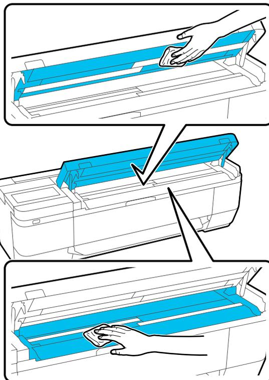
**3** Utilizzare il kit di pulizia o la parte pulita del panno morbido per pulire accuratamente la lavagna (l'area indicata in blu nella figura qui sotto).
