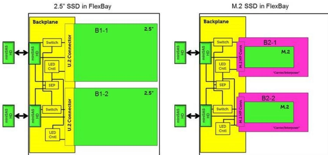
**N.B.:** Gli indicatori LED di stato o di attività funzionano solo con un backplane con ciascun alloggiamento mostrato di seguito.
