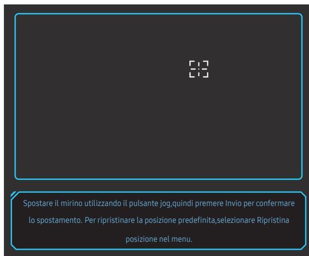
3 Una volta completata la configurazione delle impostazioni, premere il tasto Invio
