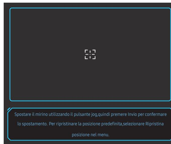
2 La posizione del mirino viene regolata di 1 pixel per singolo movimento del tasto JOG.
