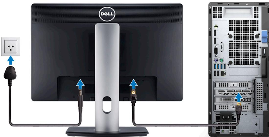
4. Schließen Sie das Stromkabel an.
