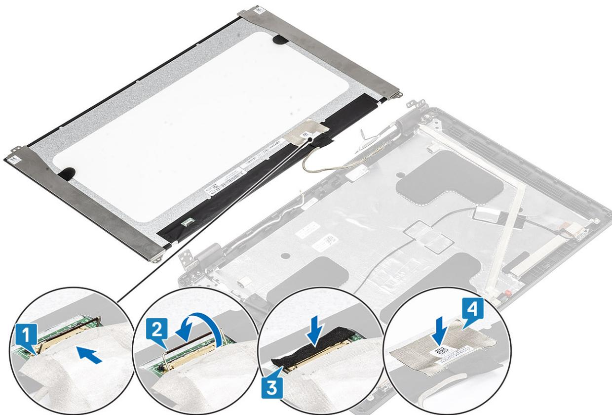
4. **i** **N.B.:** Il pannello LCD è fornito di due staffe (sinistra e destra) da inserire per prime. Procedere quindi a fissare le due viti posizionate sulla base del pannello LCD.
