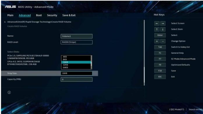
9. Quand l'élément **Capacity (MB)** (Capacité (Mo)) est sélectionné, saisissez la taille souhaitée du volume RAID, puis appuyez sur <Entrée>. La valeur par défaut indique la capacité maximale autorisée.
