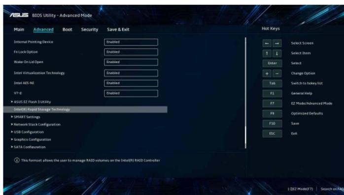
4. À partir du menu de la technologie Intel® Rapid Storage, sélectionnez **Create RAID Volume** (Créer un volume RAID), puis appuyez sur **<Entrée>**.
