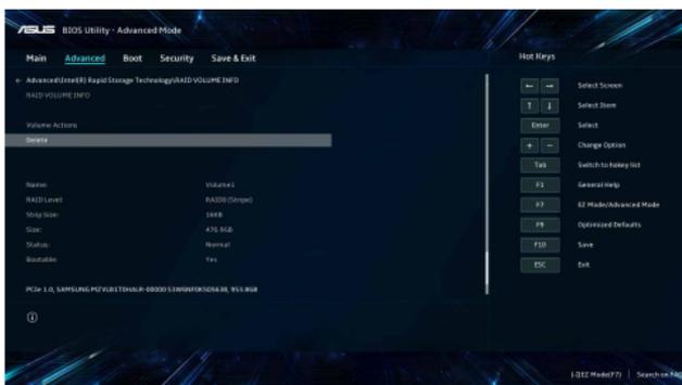
2. Quand l'élément **Delete** (Supprimer) est sélectionné, appuyez sur <Entrée>, puis sélectionnez **Yes** (Oui) pour supprimer le volume RAID et revenir au menu de la technologie Intel® Rapid Storage, ou sélectionnez **No** (Non) pour annuler.
