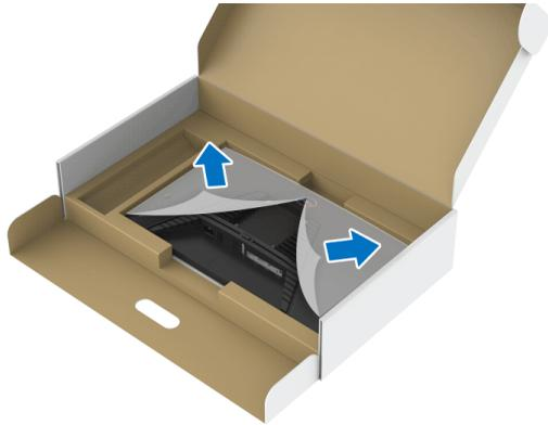
7. Schieben Sie die Laschen am Ständer in die Schlitzte an der hinteren Abdeckung des Monitors und senken Sie den Ständer ab, um ihn einrasten zu lassen.
