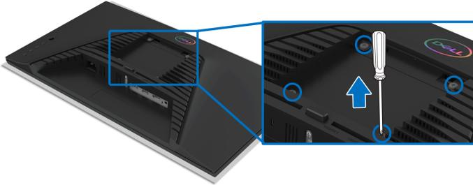
(Schraubenabmessung: M4 x 10 mm).
