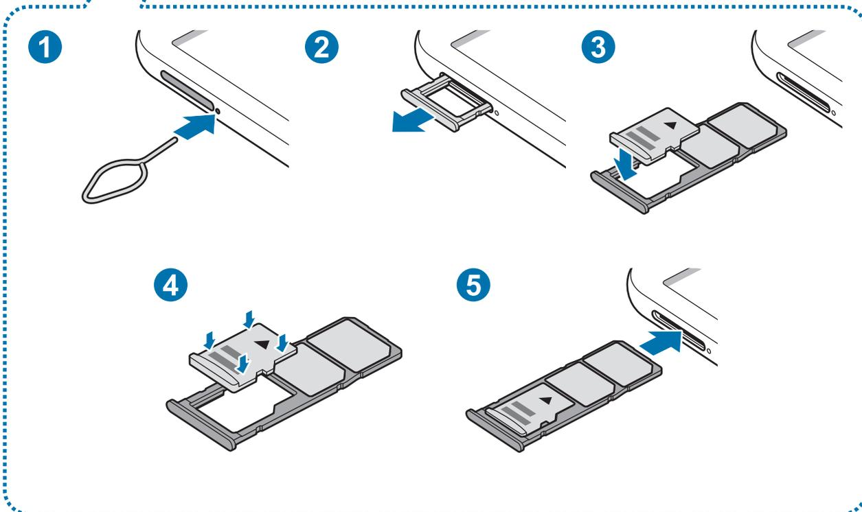
1 Para extraer la bandeja de la tarjeta SIM, inserte la anilla de extracción en el orificio junto a la bandeja.
