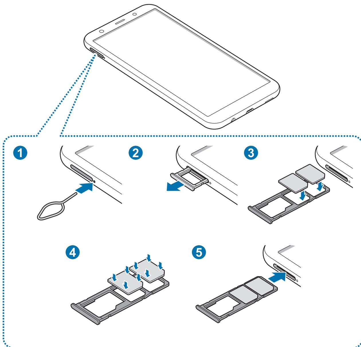
1 Para extraer la bandeja de la tarjeta SIM, inserte la anilla de extracción en el orificio junto a la bandeja.
