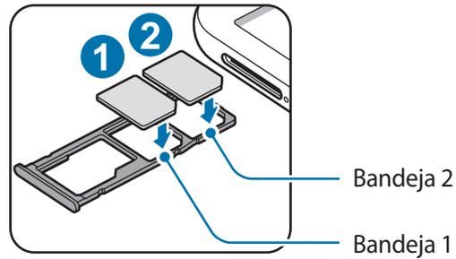
**4** Presione suavemente la tarjeta SIM o USIM hacia la bandeja para fijarla.
