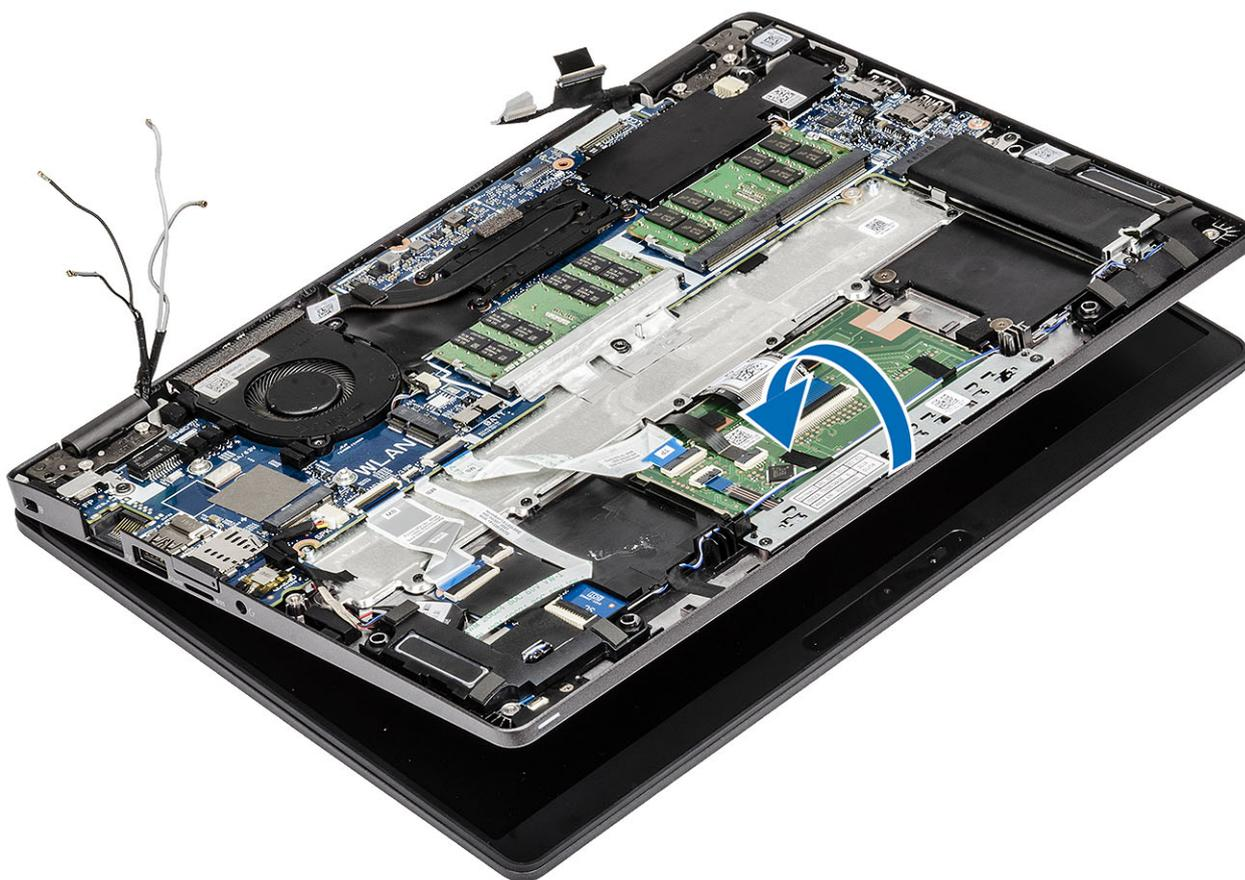
6. Retirez les quatre vis (M2,5x3) qui fixent l'assemblage d'écran au châssis du système [1].
