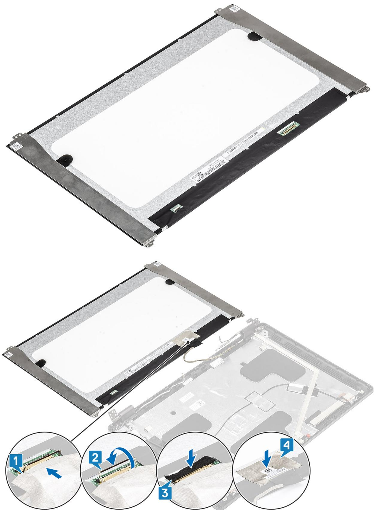
4. Ersetzen Sie die vier Schrauben (M2x2), mit denen der Bildschirm an der Bildschirmbaugruppe befestigt ist.
