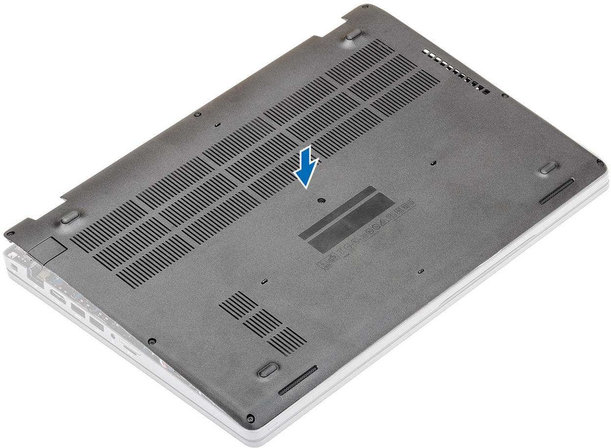
2. Üben Sie auf die Ränder der Bodenabdeckung Druck aus, bis sie hörbar einrastet.
