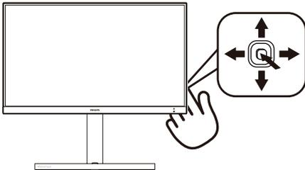
Per accedere al menu OSD del display Philips, basta usare il pulsante singolo sul retro del display. Il pulsante funziona come un joystick. Per spostare il cursore, basta spostare il pulsante nelle quattro direzioni. Premere il pulsante per selezionare l'opzione desiderata.
