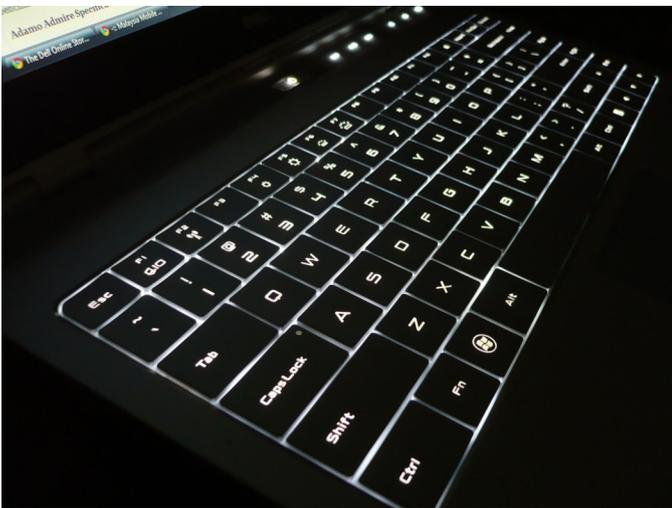
**ANMERKUNG:** Unter Umständen verfügt nicht jeder Computer über eine Tastatur mit Hintergrundbeleuchtung. Ob die Tastatur Ihres Computers über eine Hintergrundbeleuchtung verfügt, können Sie im Dokument *Quick Start Guide* (Schnellstarthandbuch) nachlesen, das mit Ihrem Computer ausgeliefert wurde. Oder lesen Sie nach unter *Setup and Specifications* (Einrichtung und technische Daten) auf [www.dell.com/support](http://www.dell.com/support).
