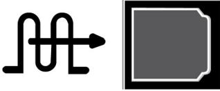
**Optical S/PDIF port** (Optischer S/PDIF-Anschluss) – Überträgt digitale Audiosignale mithilfe optischer Signale, ohne dass hierfür eine Analog-Audio-Konvertierung erforderlich ist.
