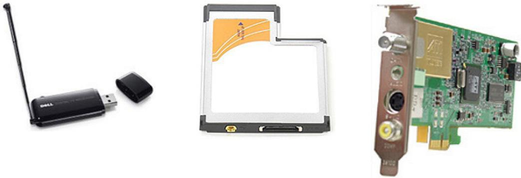
TV-Tuner sind meist Einzelgeräte, wobei jedoch bestimmte Videokarten auch über integrierte TV-Tuner verfügen. Weitere Informationen zur Verwendung eines TV-Tuners finden Sie in der Dokumentation des TV-Tuners.
