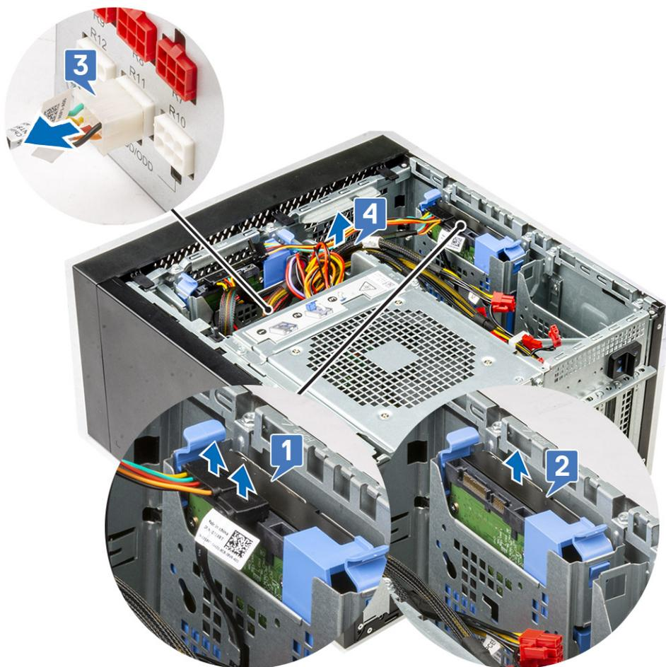
8. Biegen Sie die Festplattenhalterung seitlich nach außen [1], heben Sie das Festplattenlaufwerk [2] und ziehen Sie es aus der Halterung [3].
