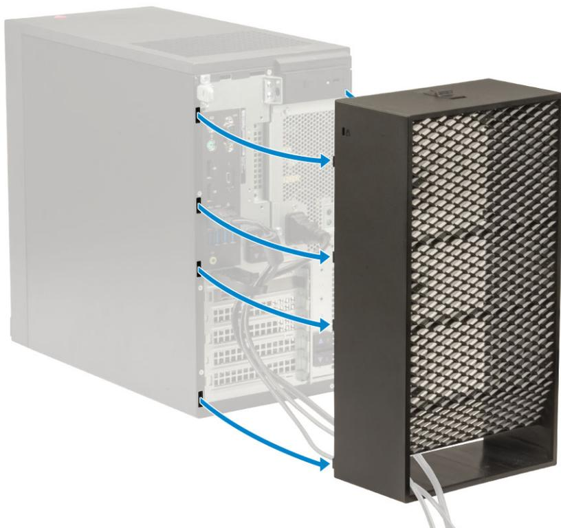
11. Öffnen Sie die Lasche und lösen Sie die Kabel aus dem Kabelbinder [1] und trennen Sie die Kabel von den Ports auf dem System [2]. Entfernen Sie die Kabel aus dem Steckplatz der Kabelabdeckung [3].
