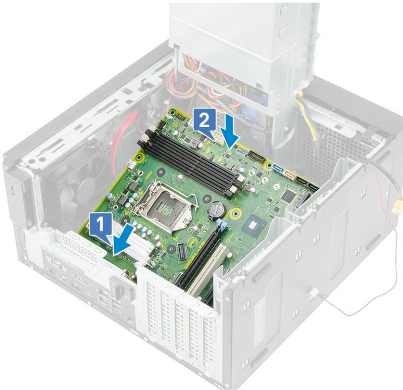
2. Bringen Sie die 8 #6-32x1/4-Zoll-Schrauben wieder an, mit denen die Systemplatine am Gehäuse befestigt ist.
