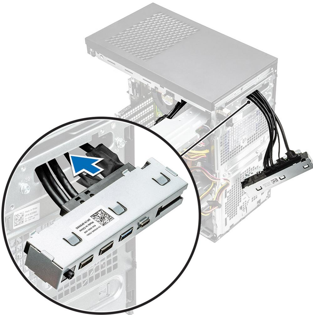
2. Setzen Sie die Laschen der E/A-Leiste in die Steckplätze auf dem System ein [1] und neigen Sie die E/A-Leiste, um sie am System zu befestigen [2].
