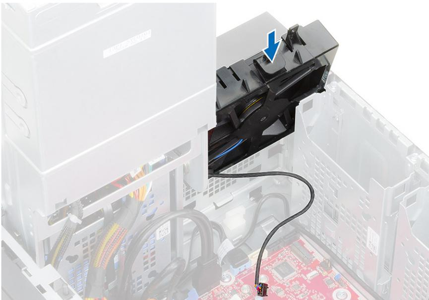
4. Drücken Sie auf die Lasche, um den vorderen Lüfter an der Halterung am Computer zu befestigen.
