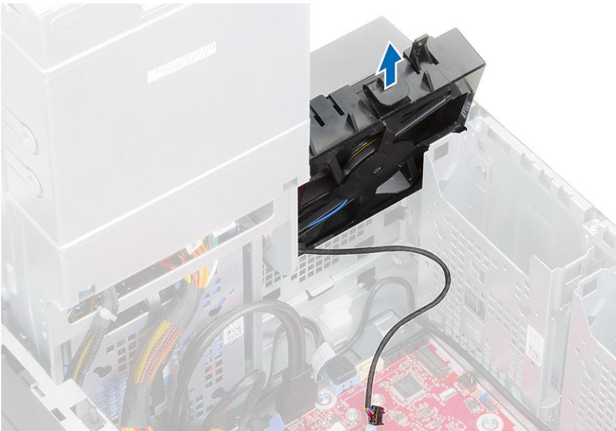
7. Lösen Sie das Lüfterkabel vom Haken am Lüfterrahmen [1] und drehen Sie den Lüfter um [2].
