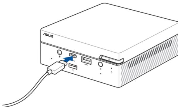
Collegamento del display tramite porta combo posteriore USB 3.2 Gen 2 di tipo C®/DisplayPort
