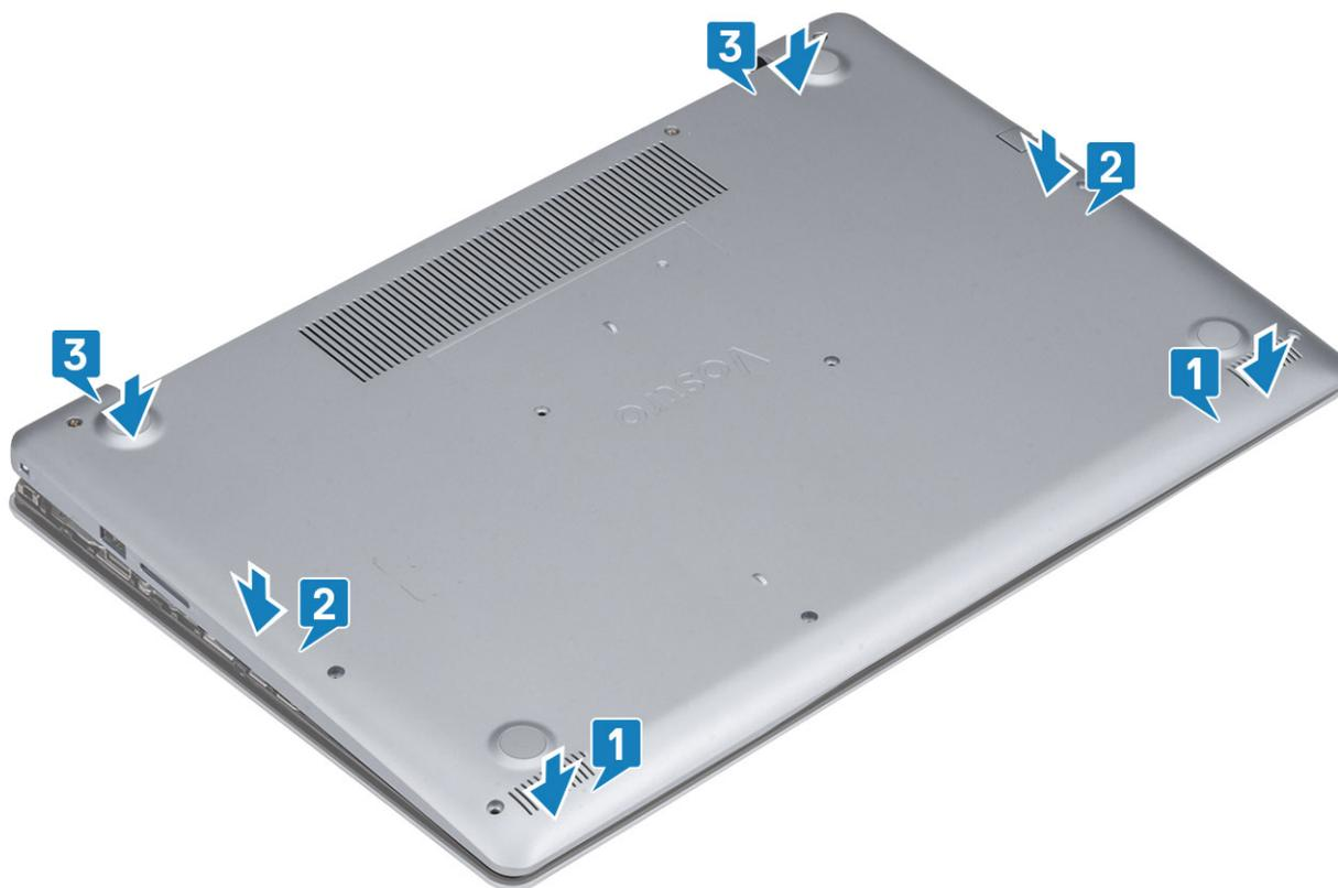
3. Serrare le tre viti di fissaggio e ricollocare la vite (M2x4) che fissa il coperchio della base al gruppo del poggiapolsi e tastiera [1, 2].
