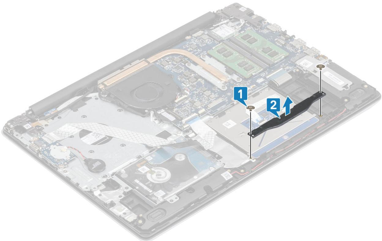
5. Retirez les quatre vis (M2x2) qui fixent le pavé tactile à l'assemblage du repose-poignets et du clavier [1].
