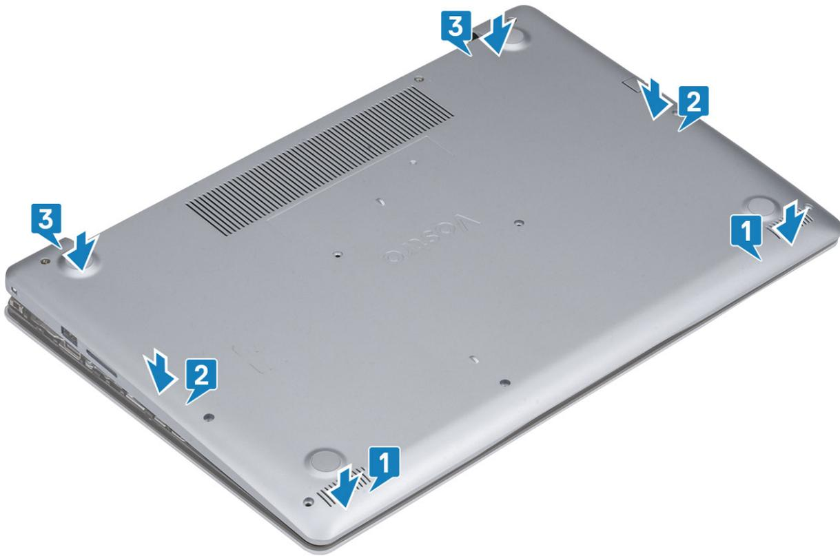
3. Serrez les trois vis imperdables et remettez en place la vis unique (M2x4) qui fixe le cache de fond à l'assemblage repose-poignets/clavier [1, 2].
