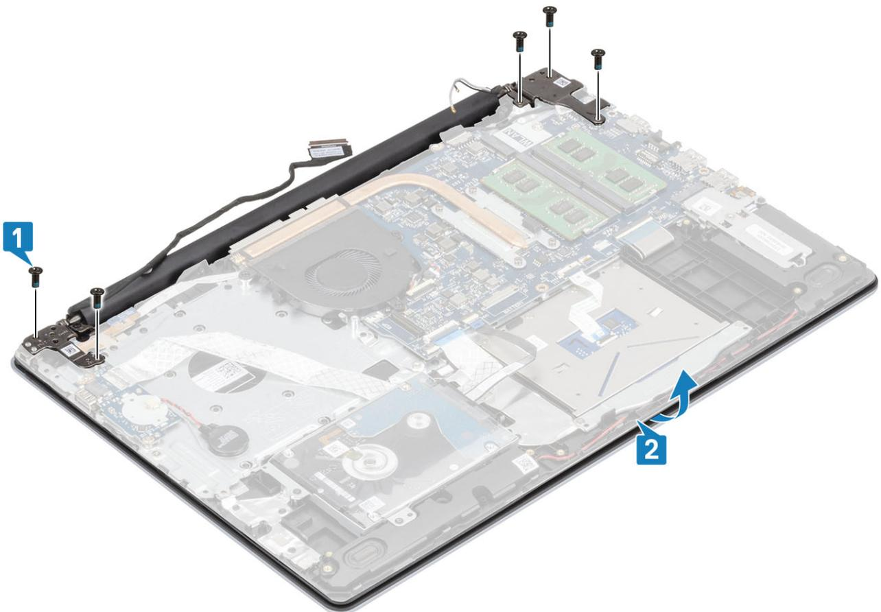
6. Soulevez les charnières. Retirez l'assemblage du repose-poignets et du clavier de l'assemblage d'écran [1, 2]
