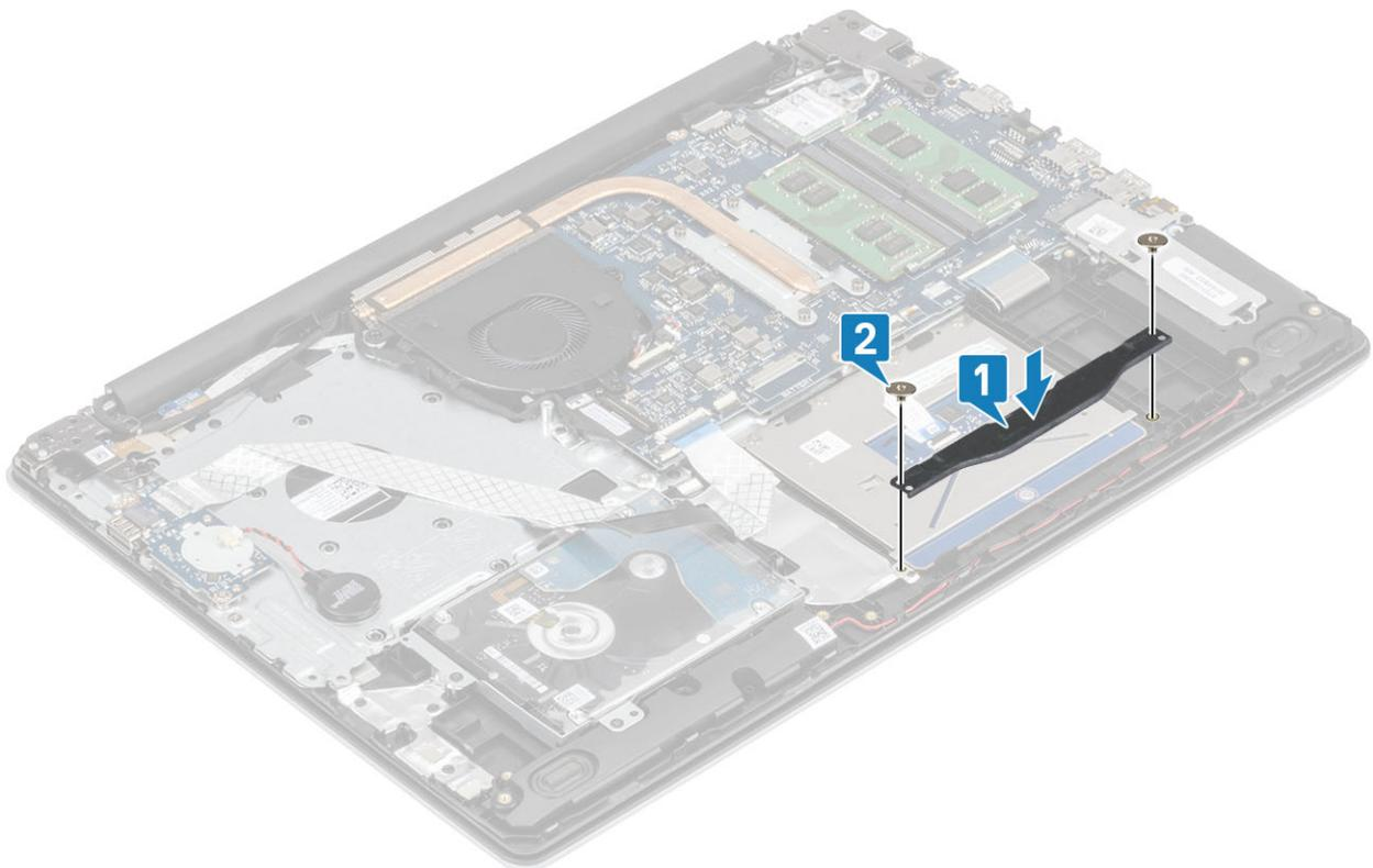
5. Collez le ruban adhésif qui fixe le pavé tactile à l'assemblage du repose-poignets et du clavier [1].
