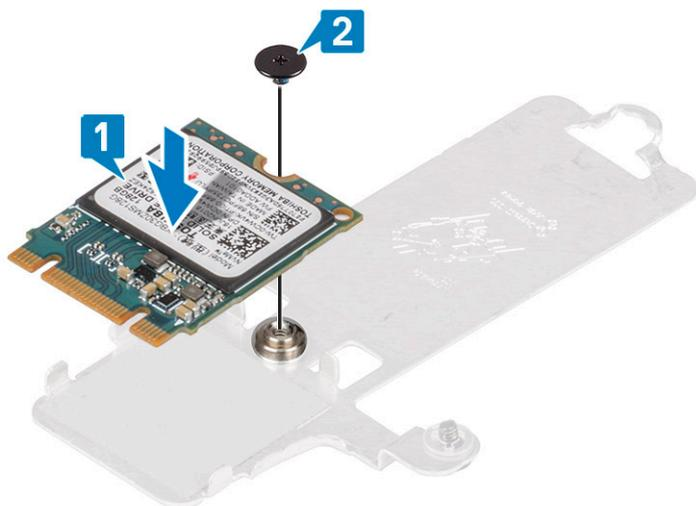
3. Alignez l'encoche du disque SSD avec la languette située sur le logement du disque SSD.
