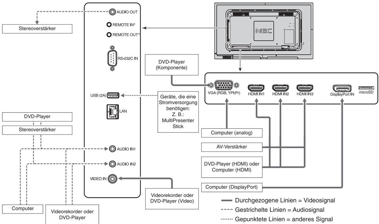
\*: Die REMOTE IN/OUT-Anschlüsse mehrerer Monitore können miteinander verkettet werden. Dadurch kann ein optionaler Fernbedienungssensorsatz für mehrere Monitore verwendet werden.
