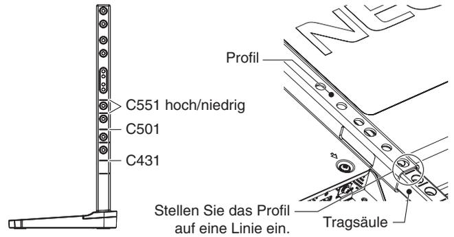
2. Fixieren Sie die Tragsäule mit den beigelegten Schrauben im Profil. Drehen Sie die Schrauben in die beiden Schraubenbohrungen im Profil ein.
