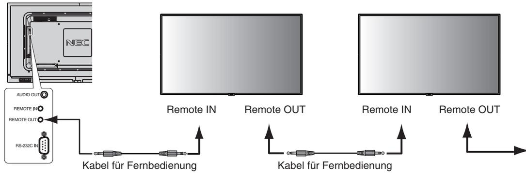
**HINWEIS:** Schalten Sie den Hauptschalter aus, bevor Sie den Stereo-Miniklinkenstecker anschließen/trennen.
