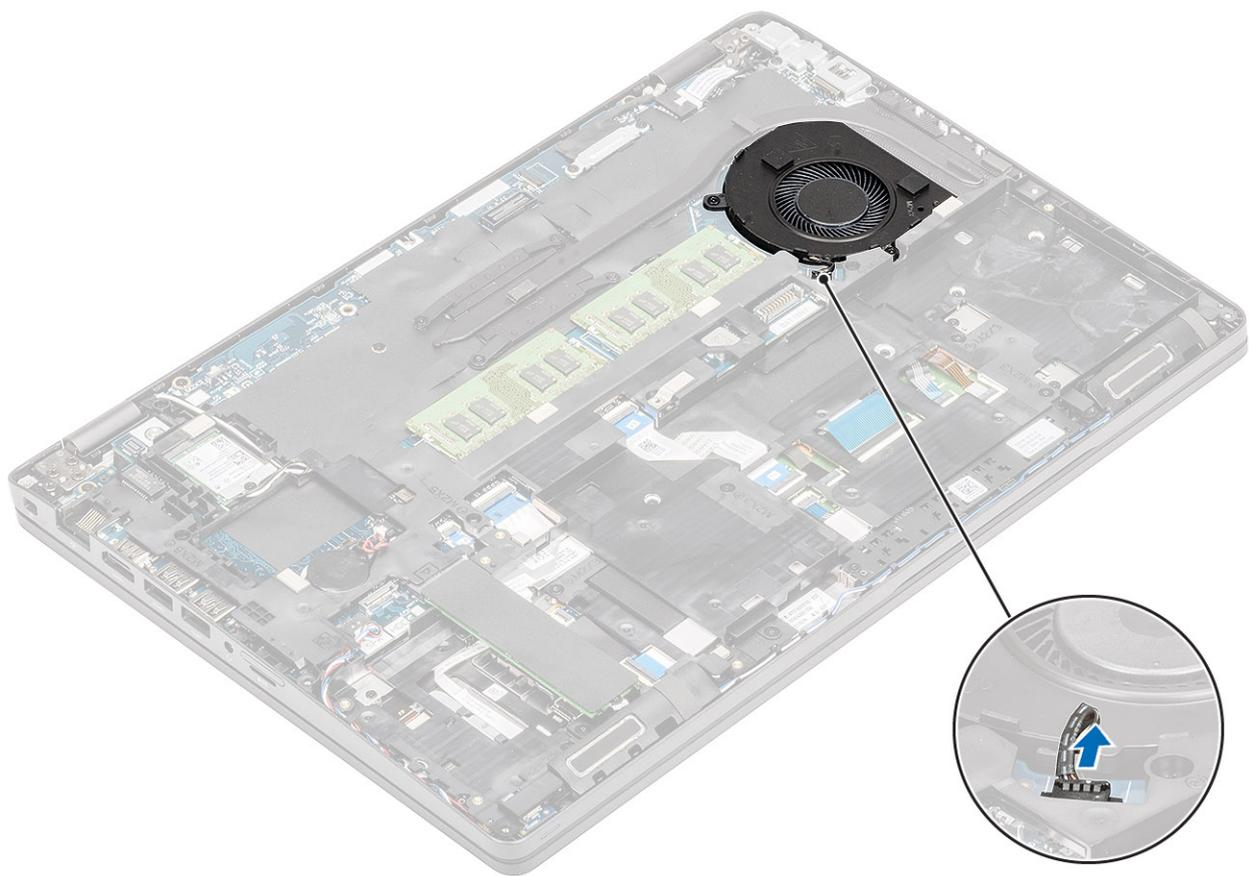
2. Retirez les deux vis (M2x5) qui fixent le ventilateur système au repose-mains [1].
