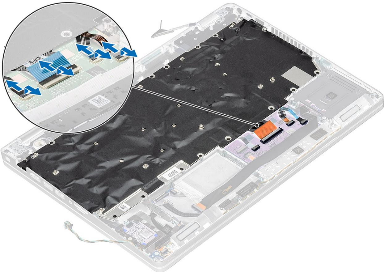
2. Retirez les 22 vis (M2x2) qui fixent le clavier au repose-poignets [1].
