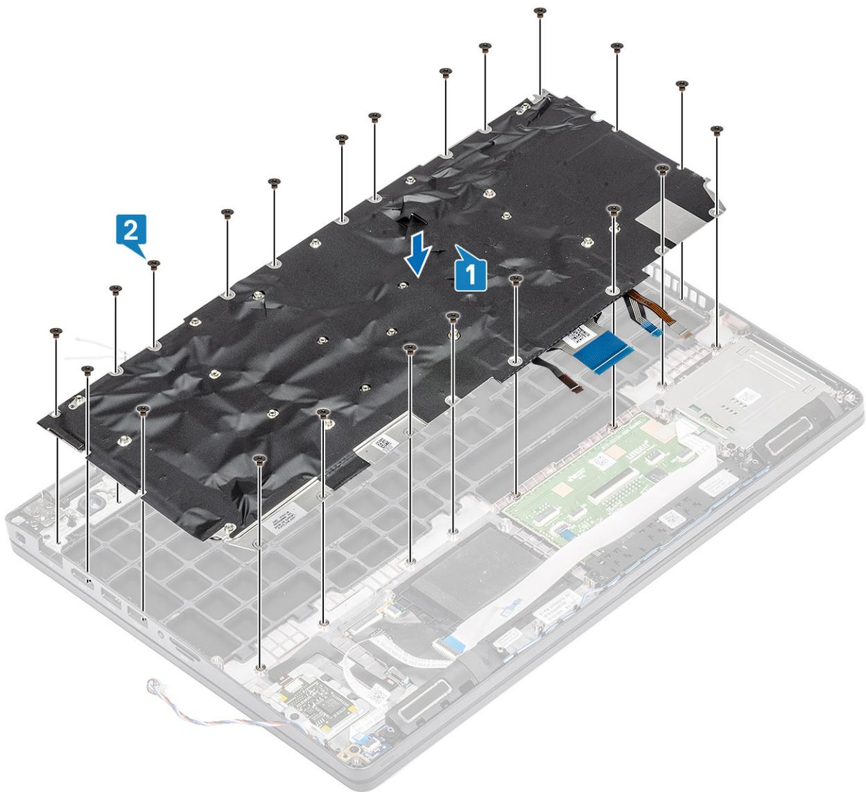
3. Branchez le câble de rétroéclairage et les câbles du clavier sur les connecteurs situés sur le pavé tactile.
