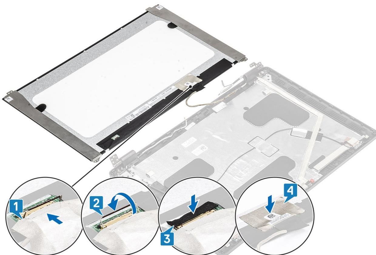
4. **REMARQUE :** L'écran LCD est fourni avec deux supports, « L » (gauche) et « R » (droite) qui doivent d'abord être enclenchés puis fixés avec les deux vis situées à la base du panneau LCD.
