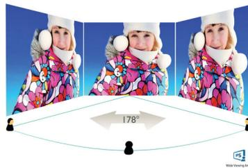
I display IPS utilizzano una tecnologia avanzata che offre un angolo visuale estremamente ampio di 178/178 gradi, rendendo possibile la visualizzazione da qualsiasi angolazione, anche in modalità di rotazione di 90°. A differenza dei pannelli TN standard, i display IPS garantiscono immagini davvero nitide dai colori naturali, così da renderli ideali non solo per foto, film e navigazione in rete, ma anche per quelle applicazioni professionali che richiedono colori accurati e costante luminosità.
