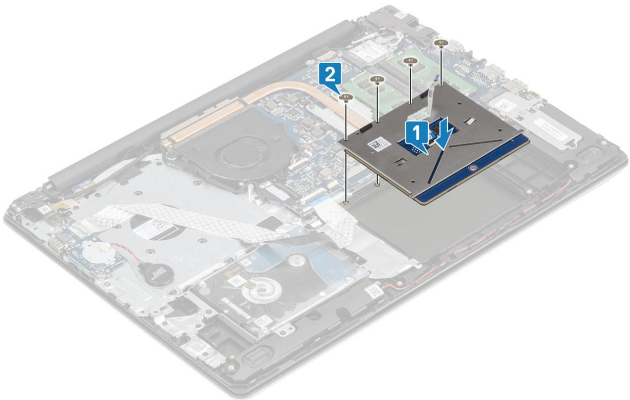
3. Coloque o suporte do painel tátil na ranhura do conjunto do teclado e descanso para os pulsos [1].
