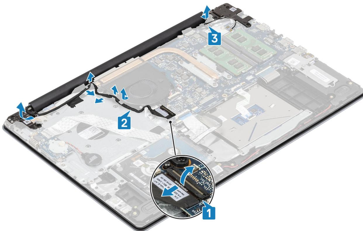
4. Retire os cinco (M2.5x5) parafusos que fixam as dobradiças esquerda e direita à placa de sistema e conjunto do teclado e descanso para os pulsos [1].
