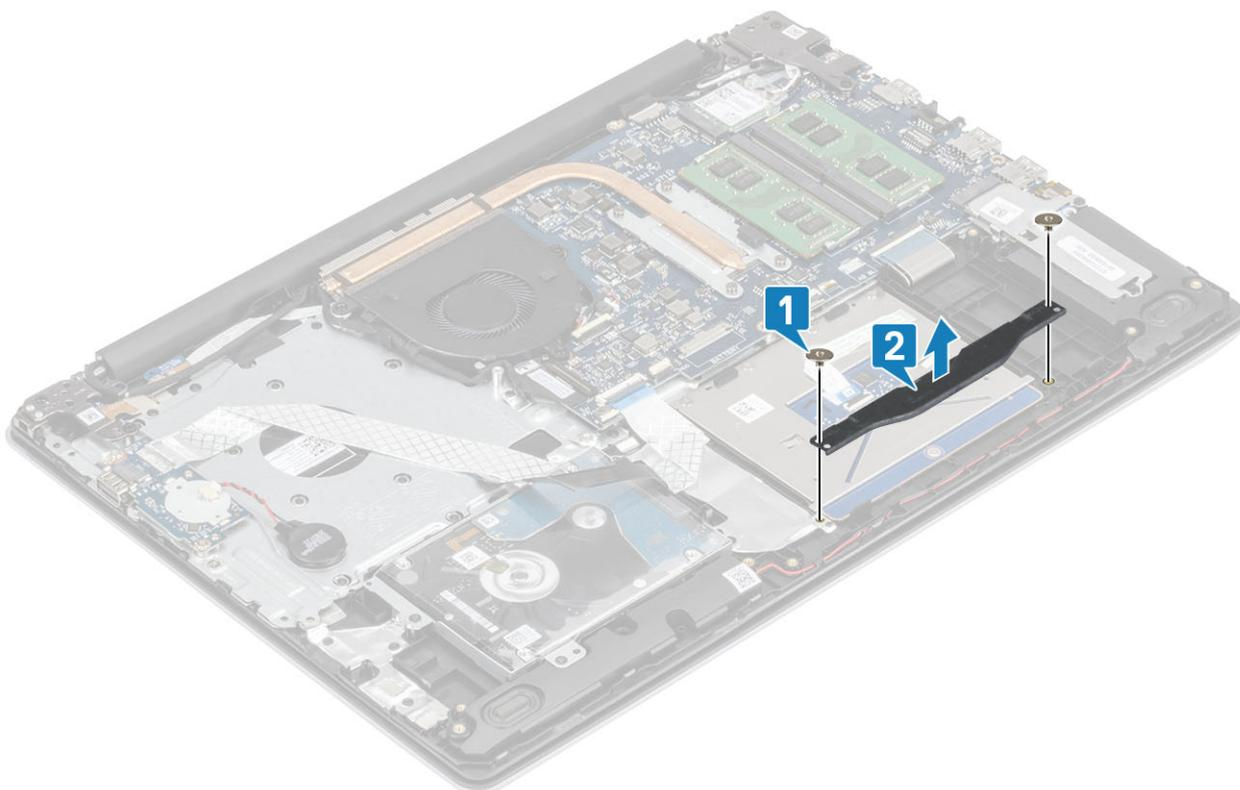
5. Retire os quatro parafusos (M2x2) que fixam o painel tátil ao conjunto do teclado e descanso para os pulsos [1].
