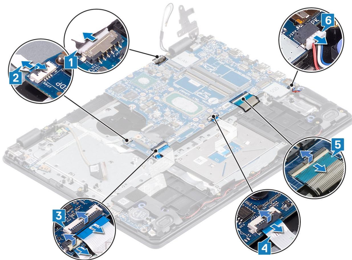
2. Retire o único parafuso (M2x4) que fixa a placa de sistema ao conjunto do teclado e descanso para os pulsos [1].
