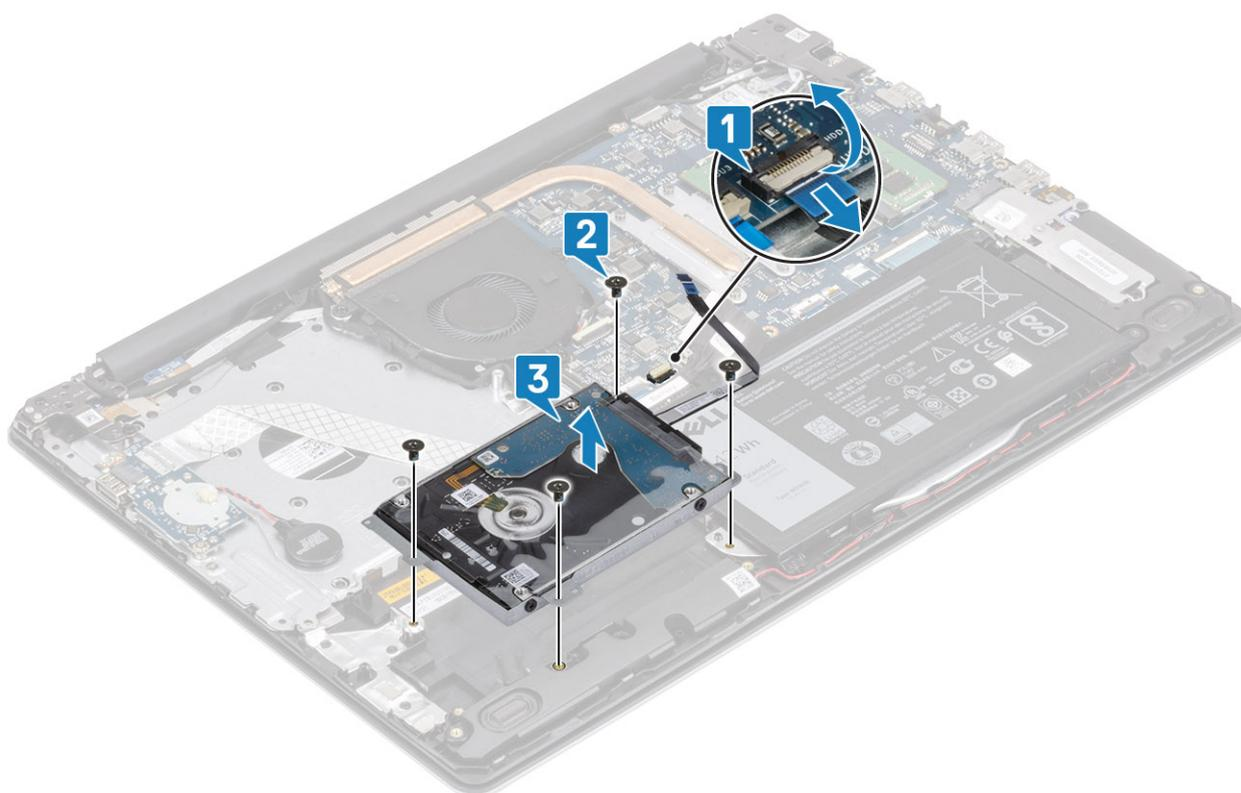
4. Desligue o elemento de interposição do disco rígido.
