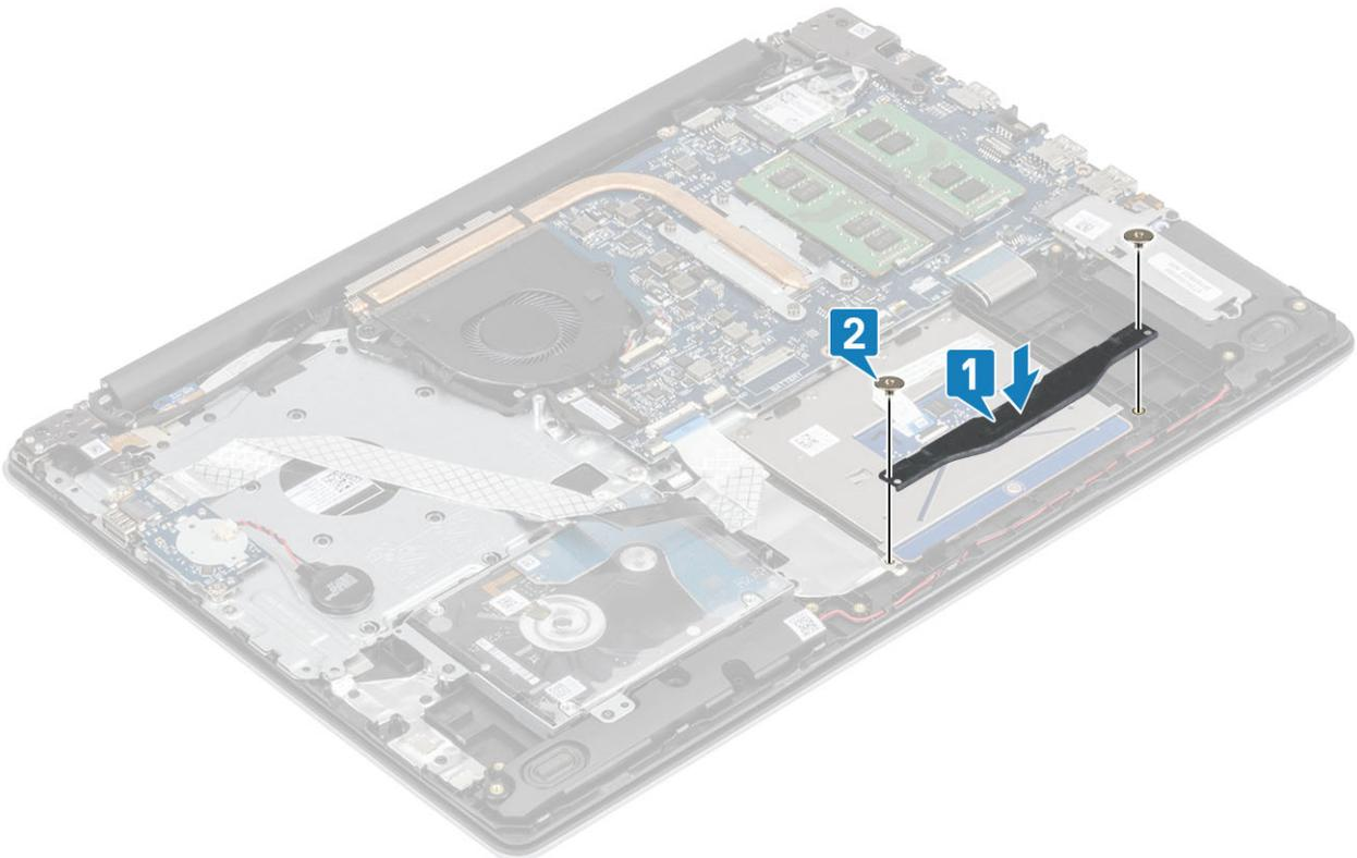
5. Cole a fita adesiva que fixa o painel tátil ao conjunto do teclado e descanso para os pulsos [1].
