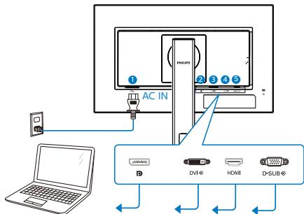
3. Connectez le câble de signal du moniteur au connecteur vidéo situé à l'arrière de votre ordinateur.
