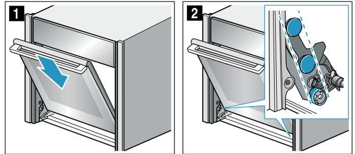
2. Achten Sie darauf, dass die Gerätetür das letzte kleine Reststück vollständig nach unten rutscht (Bild 3).
