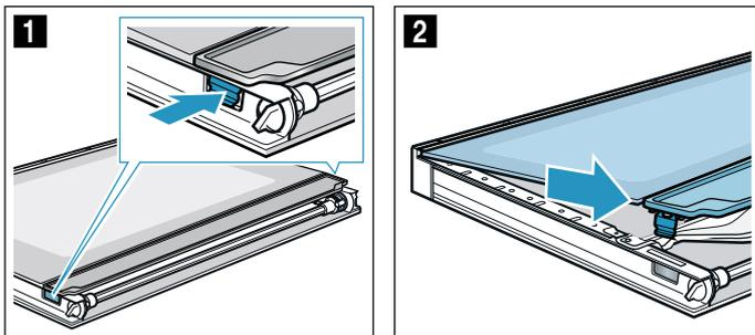
5. Zwischenscheibe im Bereich **a** nach unten drücken, Halterung **b** vorsichtig anheben, bis sie sich herausziehen lässt (Bild 3).
