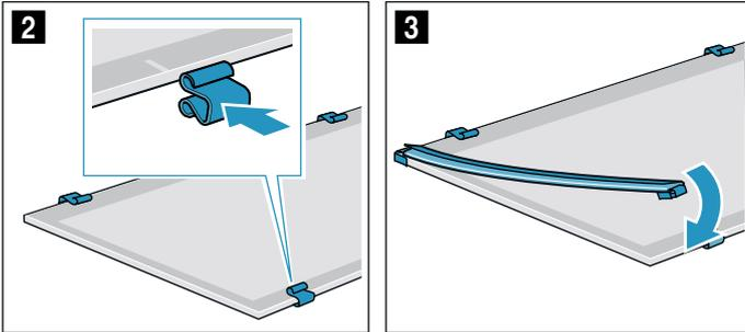
3. Zwischenscheibe mit Dichtungen und Abstandshalter einsetzen. Der Pfeil auf der Zwischenscheibe muss mit dem Pfeil auf dem Rahmen übereinstimmen (Bild 4).
