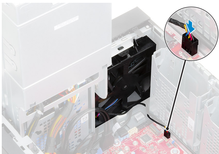
6. נתב את כבלי כרטיס הכונן הקשיח מעל תושבת המאוורר הקדמי.
