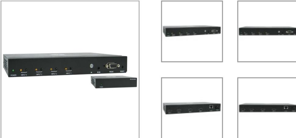
Le permite cambiar entre 4 fuentes HDMI transmitiendo video 4K con audio a un monitor HDMI ubicado a una distancia de hasta 38.1 m [125 pies].
