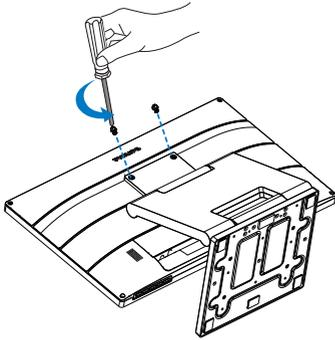
2. Mueva el soporte a la posición mostrada en la imagen. A continuación use el destornillador para quitar los tornillos y separe el soporte del monitor.
