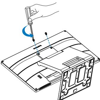
2. Deplasați suportul în poziția indicată în imagine. Apoi folosiți o șurubelnită pentru a scoate șuruburile, după care detăsați suportul de monitor.
