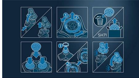
1. Pulsa los botones de liberación y desmonta el soporte del cabezal de afeitado. 2. Gira los anillos de retención hacia la izquierda y retíralos. 3. Quita los cabezales de afeitado antiguos e inserta los de repuesto (las marcas deben encajar exactamente en los salientes). 4. Vuelve a colocar los anillos de retención y gíralos hacia la derecha hasta que oigas un clic. 5. Vuelve a insertar el soporte de la afeitadora y ciérralo.
