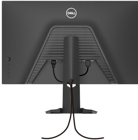
Depois de conectar todos os cabos necessários ao monitor e ao computador, (consulte [Conectando seu monitor](#) para conexão de cabos) organize todos os cabos como mostrado acima.
