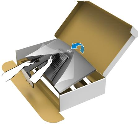
**NOTA:** Segure a base do suporte firmemente ao levantar o monitor para evitar qualquer dano acidental.
