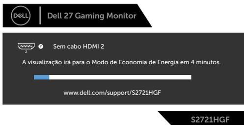
4. Esta caixa também aparece durante a operação normal do sistema se o cabo de vídeo for desconectado ou danificado.
