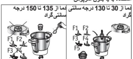
هنگامی که درجه حرارت بین ۱۳۵ تا ۱۵۰ درجه سانتی گراد را انتخاب کرده اید، پاید از دستگاه خود بدون سرپوش استفاده کنید. اگر سرپوش روی کاسه قرار گرفته باشد، قفل LCD نمایش داده می شود و از شما می خواهد آن را باز کنید.
