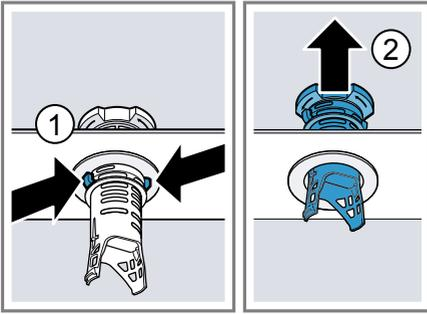
5. Unter fließendem Wasser die Siebelemente reinigen.
